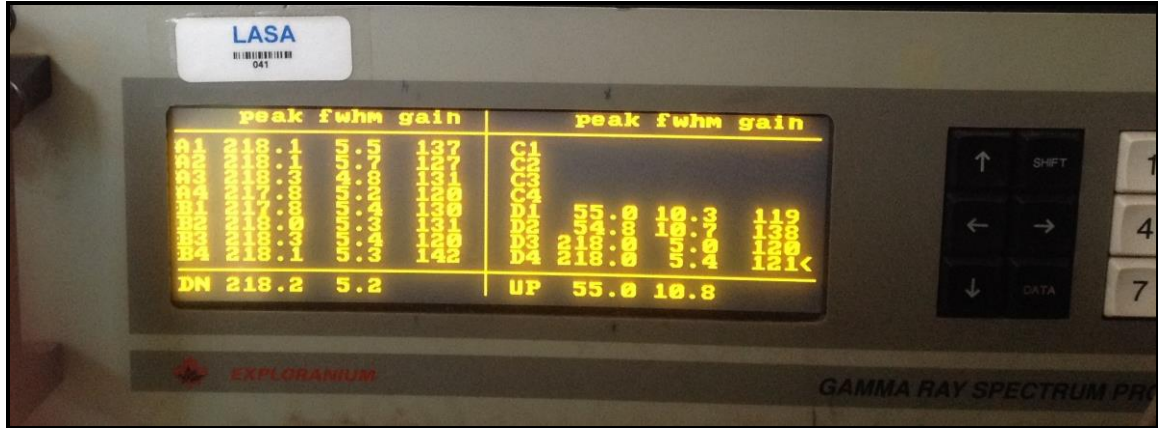
Foto tirada no dia 01/11/2013 no hangar em Jacarepaguá mostrando a resolução dos cristais do sistema Exploranium GR820 da aeronave PT-MEP
