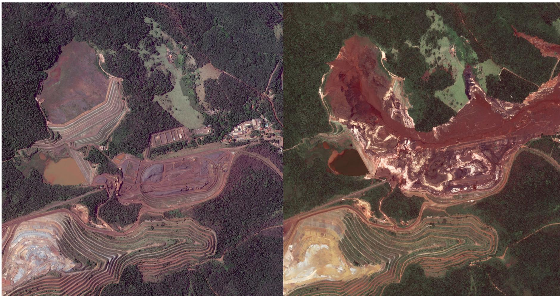
Figura 3-19 - Área da barragem da mina do Córrego do Feijão antes e depois da ruptura da barragem. Fonte: Google Earth
