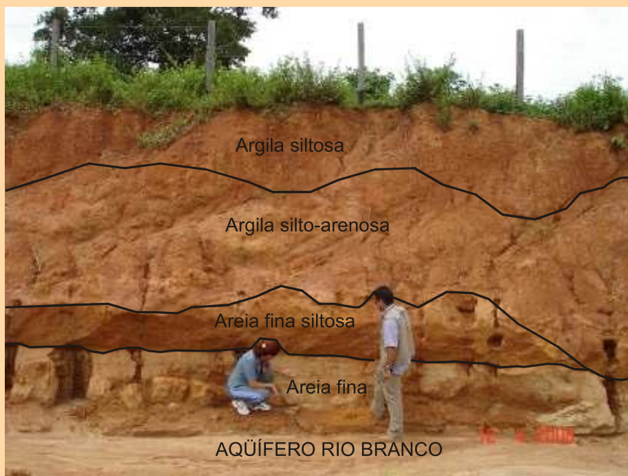
Fotografia 04: Identificação do aquífero Rio Branco no anel viário da capital acreana, onde estão ilustradas as camadas aquífera e aquífuga do sistema avaliado.
