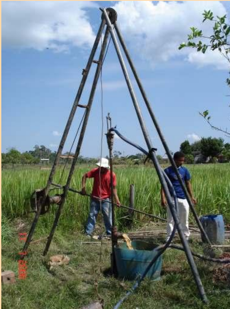
Fotografia 06: Sondagem a trado realizada na Vila da Amizade, para o mapeamento de subsuperfície do aquífero Rio Branco.
