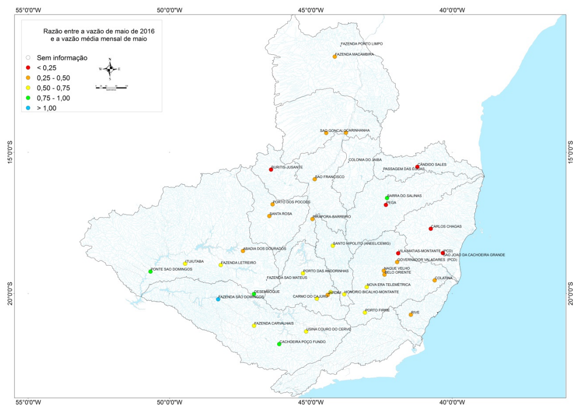
Figura 8 - Razão entre a vazão de maio de 2016 e a vazão média mensal de maio.
