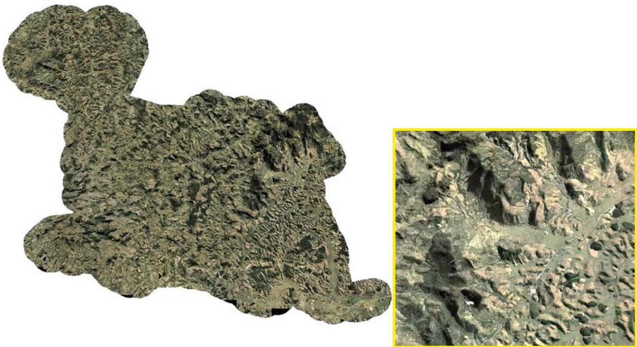
Figura 13 - Arquivo raster resultante da fusão entre as ortofotos digitais e o MDE do município de Mimoso do Sul, com limite acrescido de 2 km de buffer. Destaca-se a acurácia da imagem em distintas escalas de apresentação (modificado de DANTAS et al. , 2014)
