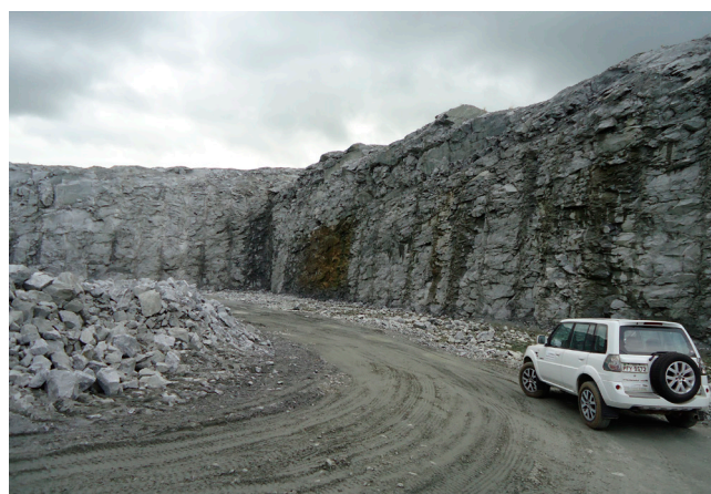
Figura 3.4 - Metagranitoide fanerítico equigranular leucocrático. Localmente, observam-se veios de quartzo. A rocha apresenta-se bastante fraturada. Granitoides Indiscriminados – Atalaia/AL (Afloramento KC 085). Fonte: Klaryanna Cabral Alcantara, 2018.
