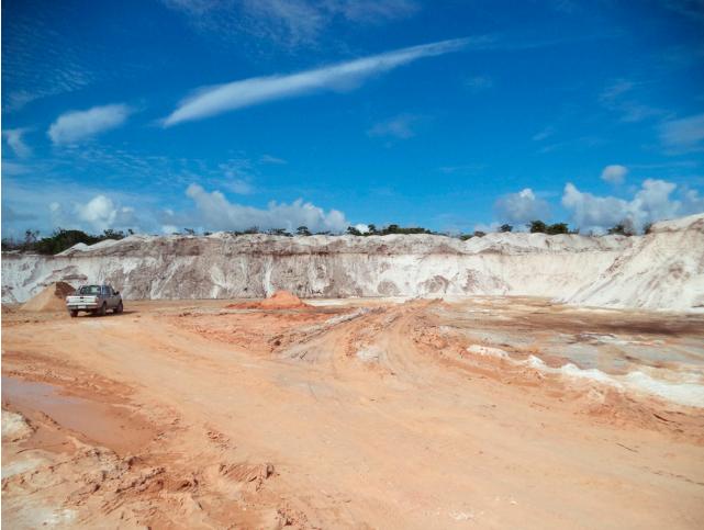
Figura 4.5 - Frente de lavra de areia em sedimentos de depósitos litorâneos. Depósitos litorâneos - Marechal Deodoro/AL (Afloramento KC 013). Fonte: Klaryanna Cabral Alcantara, 2018.
