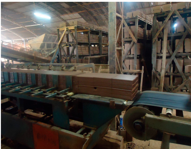
Figura 5.12 - Vista da “maromba” confeccionando tijolos de seis furos. Atalaia/AL (Ponto KC 047). Fonte: Klaryanna Cabral Alcantara, 2018.
