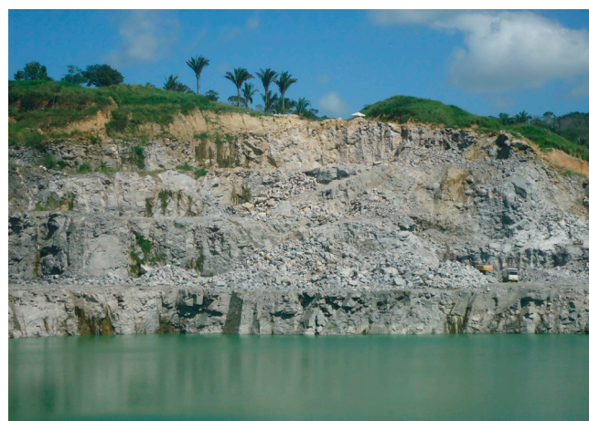
Figura 5.1 - Frente de lavra em bancadas escalonadas. Granitoides Indiscriminados – Rio Largo/AL (Afloramento KC 087). Fonte: Klaryanna Cabral Alcantara, 2018.
