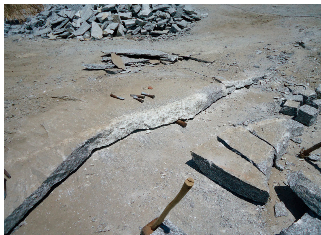
Figura 5.5 - Escopros e marretas utilizadas na confecção dos paralelos. Complexo Belém de São Francisco – Murici/AL (Afloramento KC 113). Fonte: Klaryanna Cabral Alcantara, 2018.
