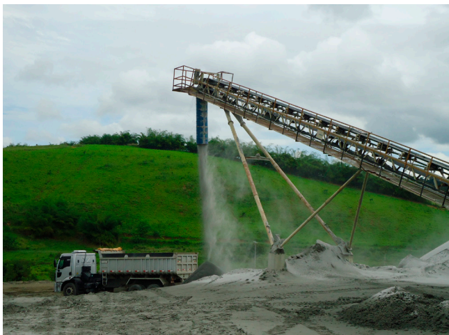
Figura 6.4 - Constante camada de fumaça no pátio de britagem, Granitoides Indiscriminados – Município de Muriçi/AL (Afloramento KC 086). Fonte: Klaryanna Cabral Alcantara, 2018.
