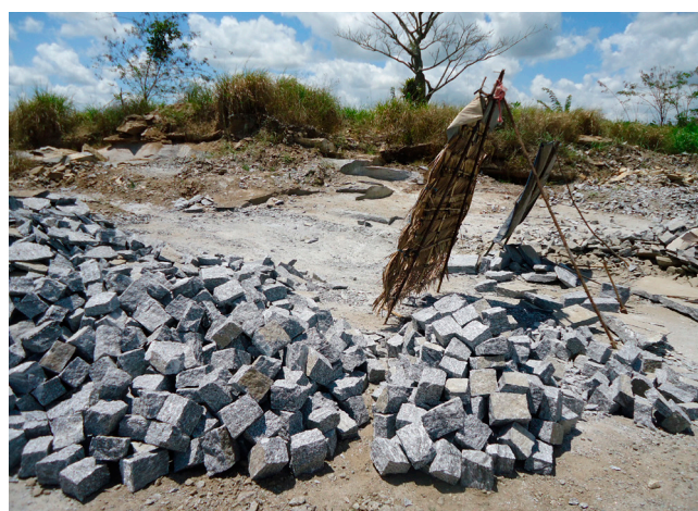
Figura 5.6 - Paralelos de rocha prontos para a comercialização (paralelepípedos). Complexo Belém de São Francisco – Murici/AL (Afloramento KC 113). Fonte: Klaryanna Cabral Alcantara, 2018.
