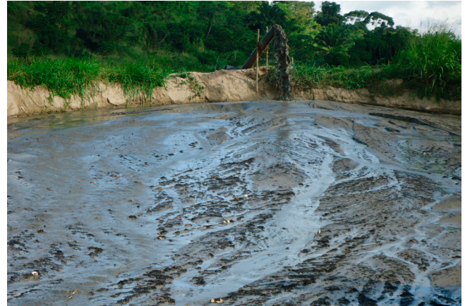
Figura 5.8 - Conductor que transporta o material da polpa até o depósito nas margens. Depósitos fluviolagunares – Pilar/AL (Afloramento KC 074). Fonte: Klaryanna Cabral Alcantara, 2018.
