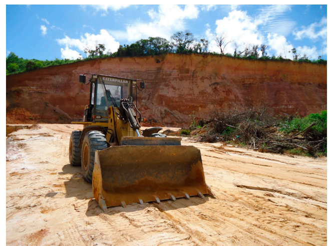
Figura 5.14 - Pá carregadeira utilizada para desmonte mecânico da lava de material de empréstimo. Grupo Barreiras – Marechal Deodoro/AL (Afloramento KC 012). Fonte: Klaryanna Cabral Alcantara, 2018.
