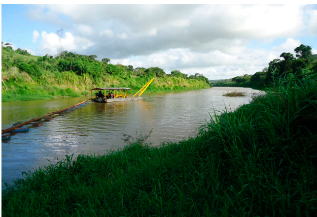
Figura 5.7 - Sistema de barcaça fixa sustentada por tambores flutuantes. Depósitos fluviolagunares – Pilar/AL (Afloramento KC 074). Fonte: Klaryanna Cabral Alcantara, 2018.
