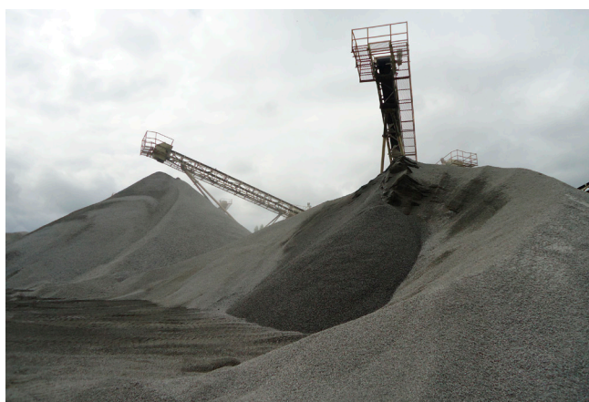
Figura 5.4 - Conjunto de correia transportadora utilizado para formação da pilha do produto final. Granitoides Indiscriminados – Rio Largo/AL (Afloramento KC 087). Fonte: Klaryanna Cabral Alcantara, 2018.
