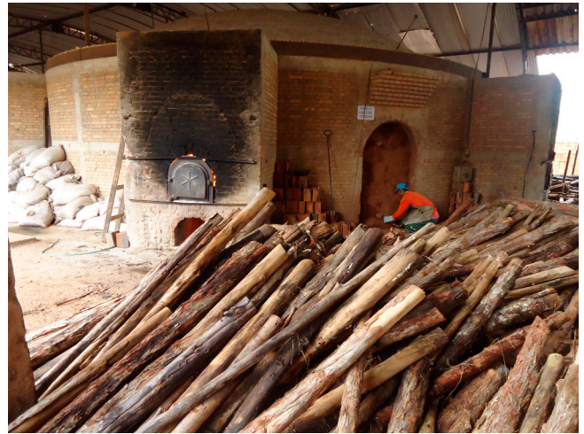
Figura 5.13 - Forno para queima do material cerâmico. Atalaia/AL (Ponto KC 047). Fonte: Klaryanna Cabral Alcantara, 2018.
