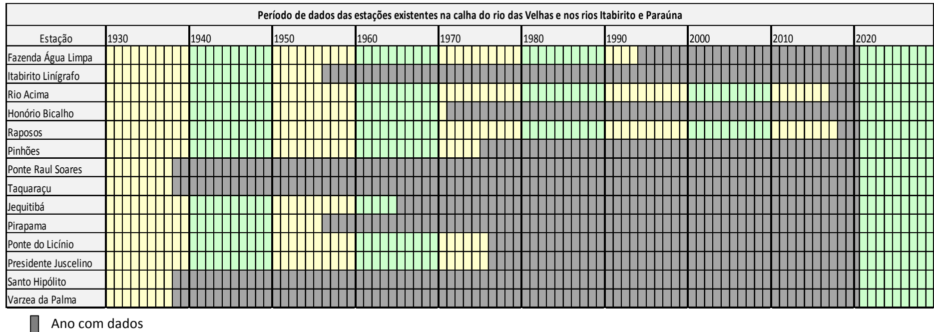
Figura 13 - Diagrama de dados relativo à extensão das séries de cotas nas estações fluviométricas utilizadas no Sistema de Alerta (só mostra a extensão das séries, não mostra os períodos com falhas)
