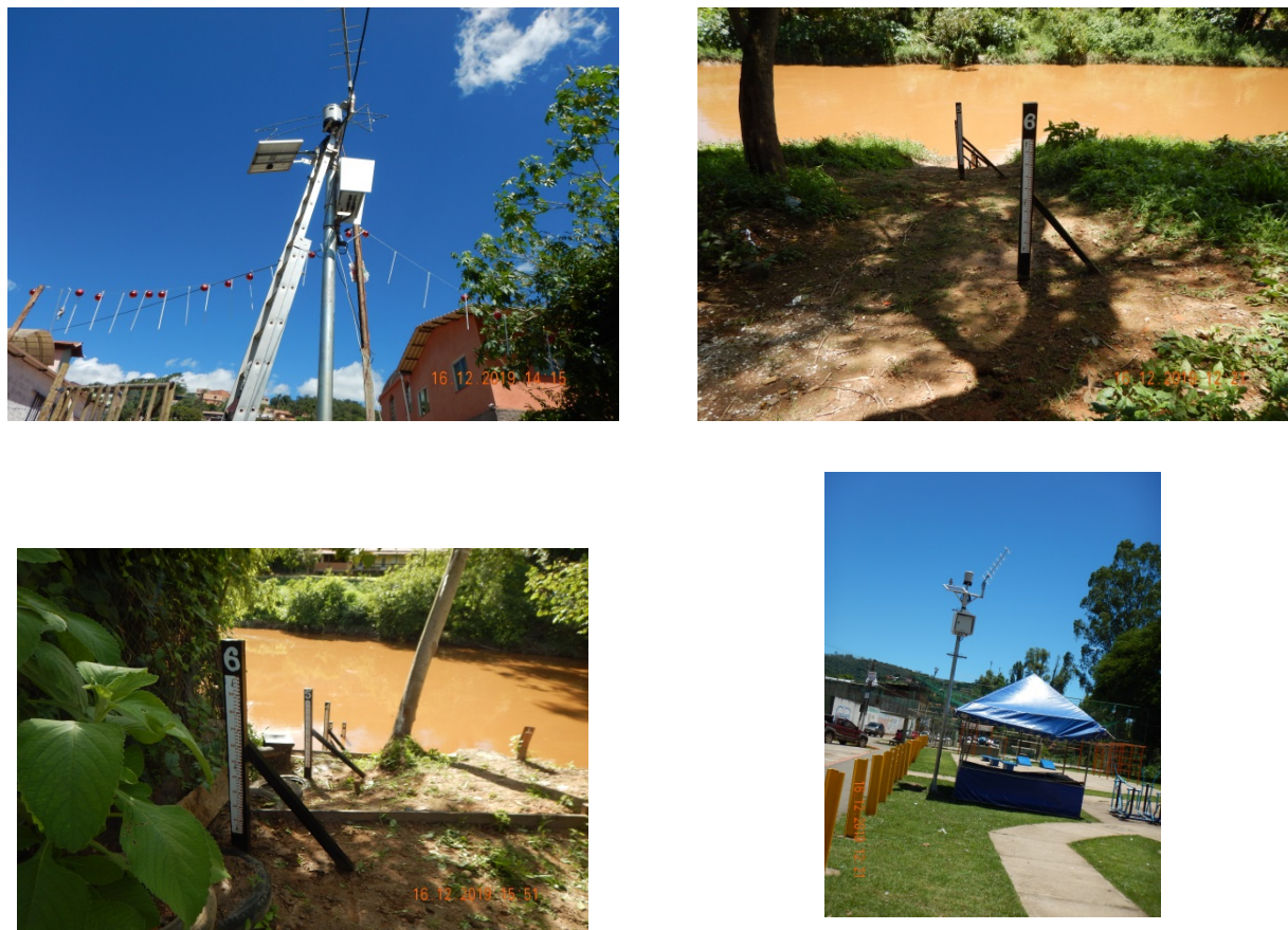
Figura 20 - Réguas e PCD instaladas em Rio Acima (à esquerda) e Raposos (à direita)
