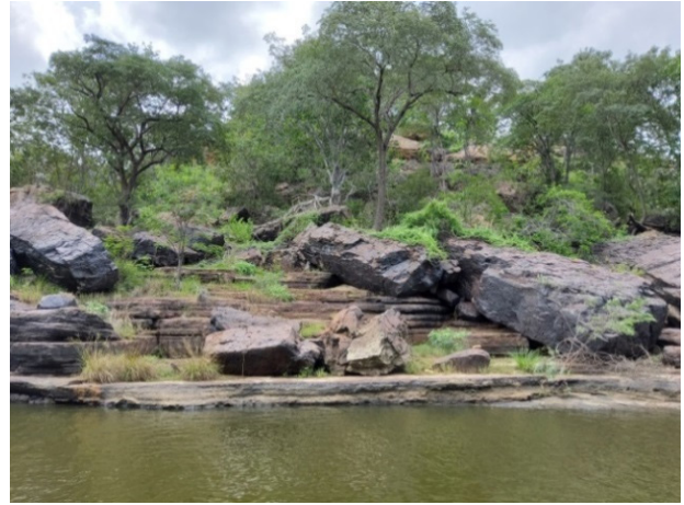
Figura 22 - Fraturas verticais com blocos métricos mobilizados por instabilidade entre as descontinuidades que apresentam sinais de decomposição e solução dos materiais alterados.
