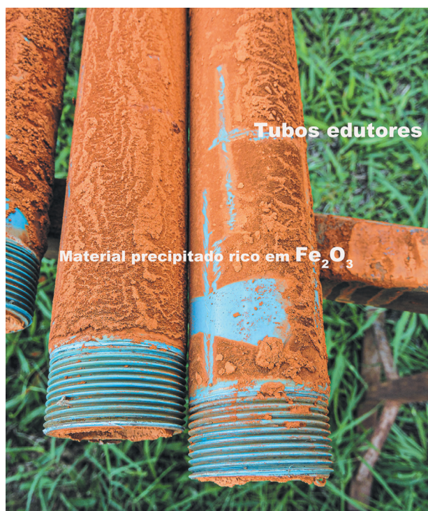
Figura 7.16. Tubos edutores retirados do poço, com material precipitado a base de ferro.
