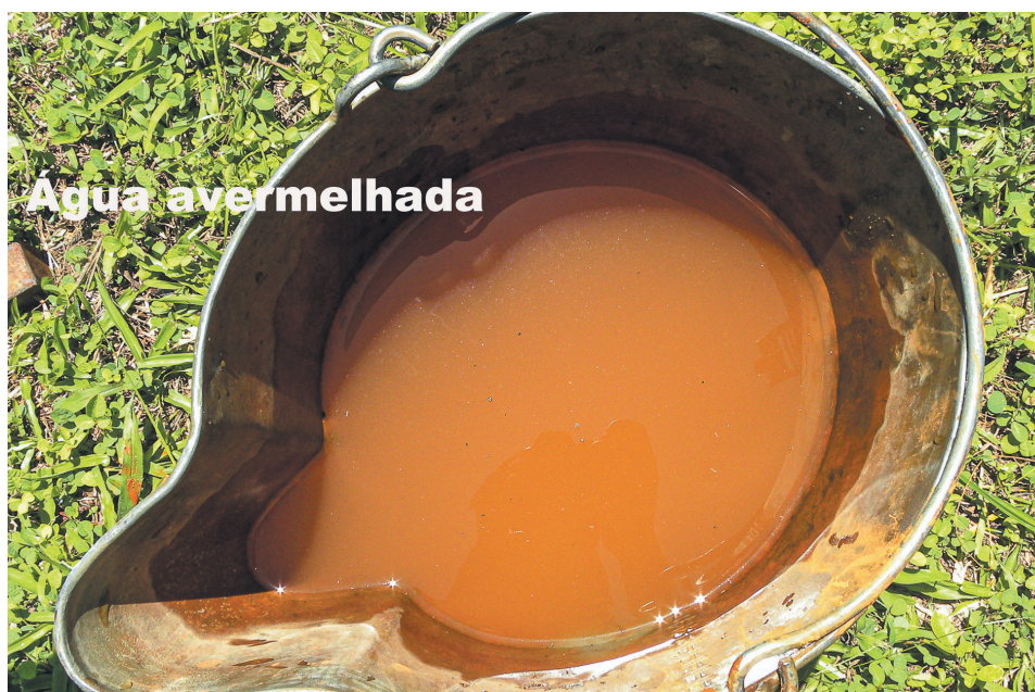
Figura 7.14. Água avermelhada retirada no início do bombeamento e constituída por material precipitado de \text{Fe}_2\text{O}_3 .
