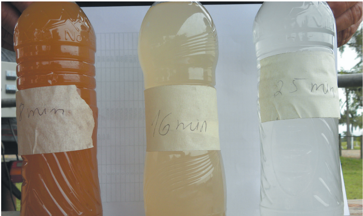
Figura 7.6. Exemplo da evolução da turbidez da água do poço tubular conforme o andamento do seu bombeamento. Da esquerda para a direita, o tempo de bombeamento é de 08, 16 e 25 minutos.
