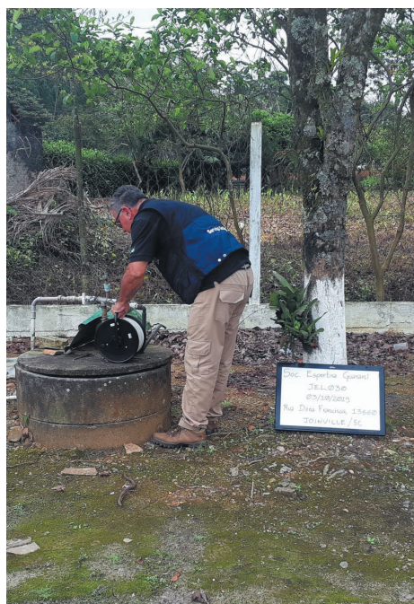
Figura 5.4. Medição de nível de água em poço escavado localizado no Clube Guarani, Pirabeiraba.
