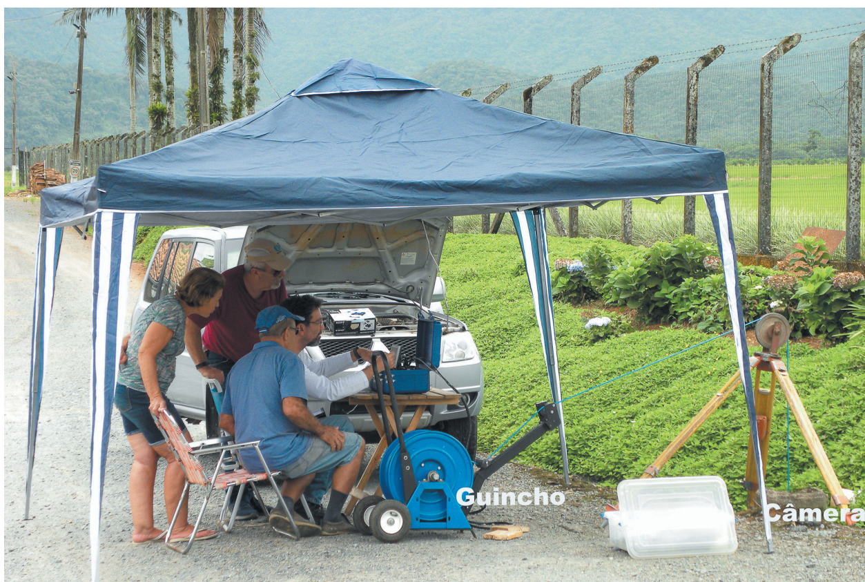
Figura 7.2. . Equipamento de videoendoscopia utilizado no poço JML-010: guincho e câmera.
