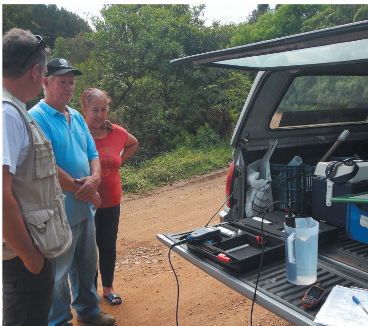
Figura 5.3. Medição in loco com sonda multiparamétrica das características físico-químicas das águas subterrâneas.
