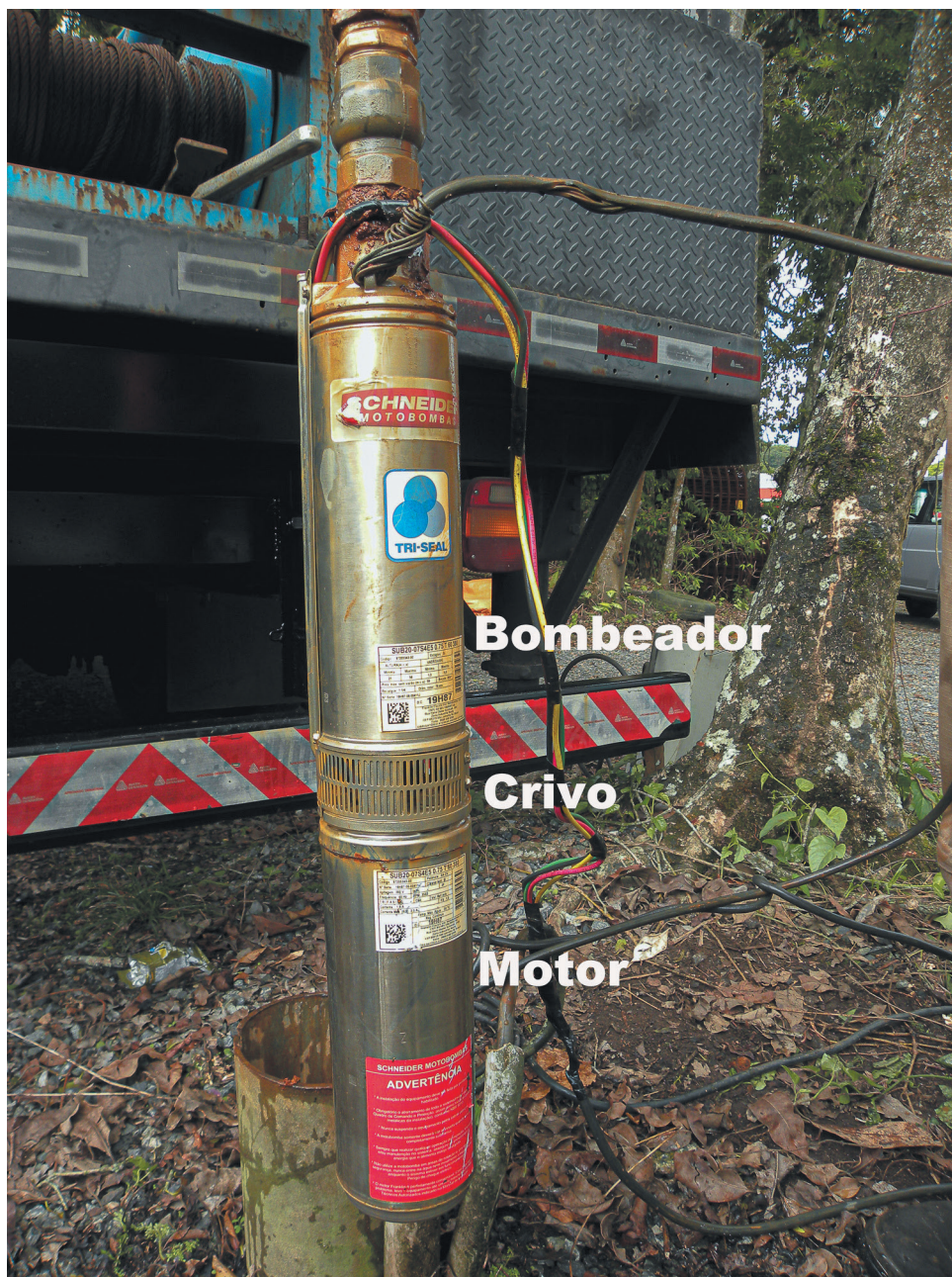
Figura 16 – Bomba submersa para extração de água de poços.
