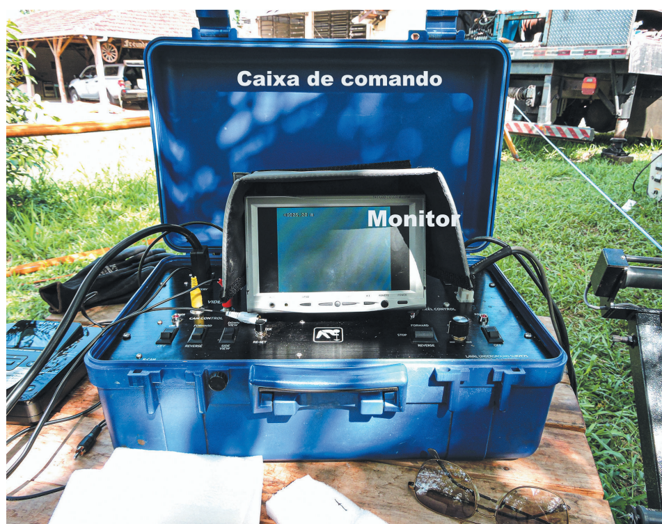
Figura 7.1. Equipamento de videoendoscopia utilizado no poço JML-010: Caixa de comando, monitor câmera de videoendoscopia.
