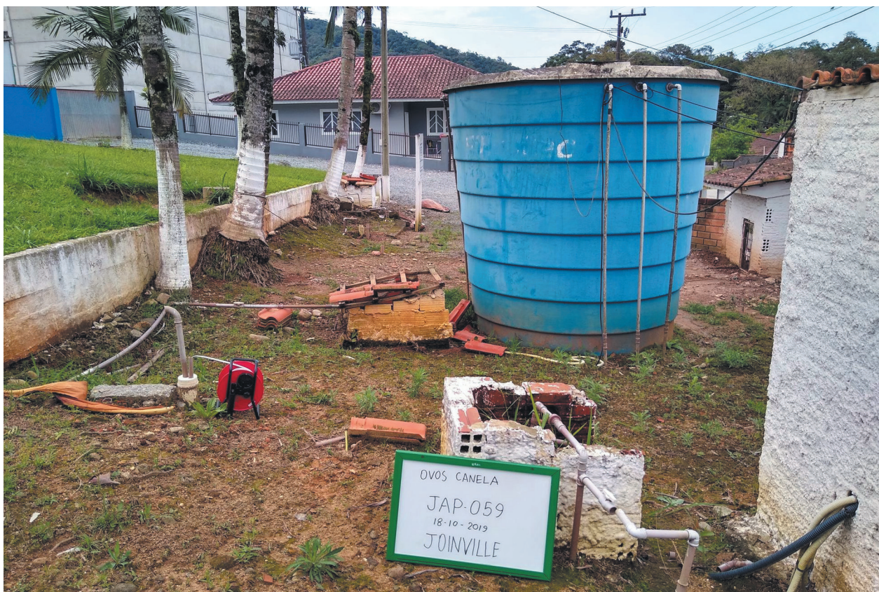
Figura 5.5. Medição de nível dinâmico em poço de pequeno diâmetro (à esquerda da foto) na Vila Canela.
