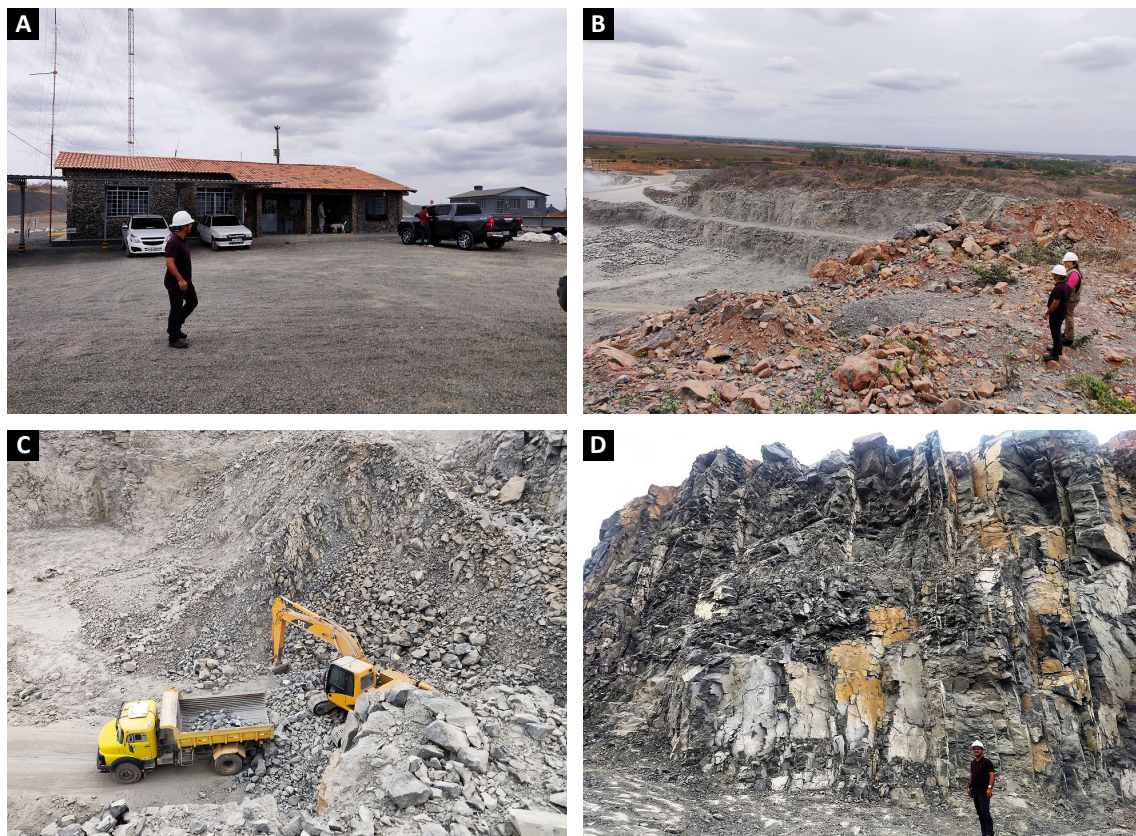
Figura 4.10 - Imagens da Granada Mineração. (A) Instalações da Granada Mineração; (B) Vista a partir da bancada superior na lavra; (C) Maquinário trabalhando na frente de lavra; (D) Frente de lavra na bancada superior mostrando disjunções colunares decimétricas e zona de falha (plano de cor clara).
