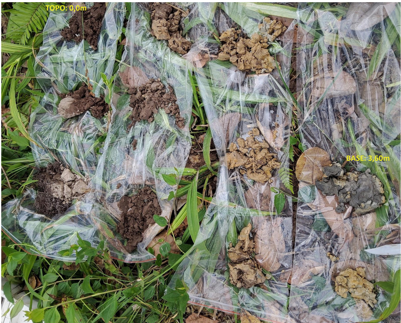
Figura 17 - Ponto de campo no. 33: Amostra de sondagem a trado de areia fina argilosa, cinza e amarelo variegado. NA: 1,10m.
