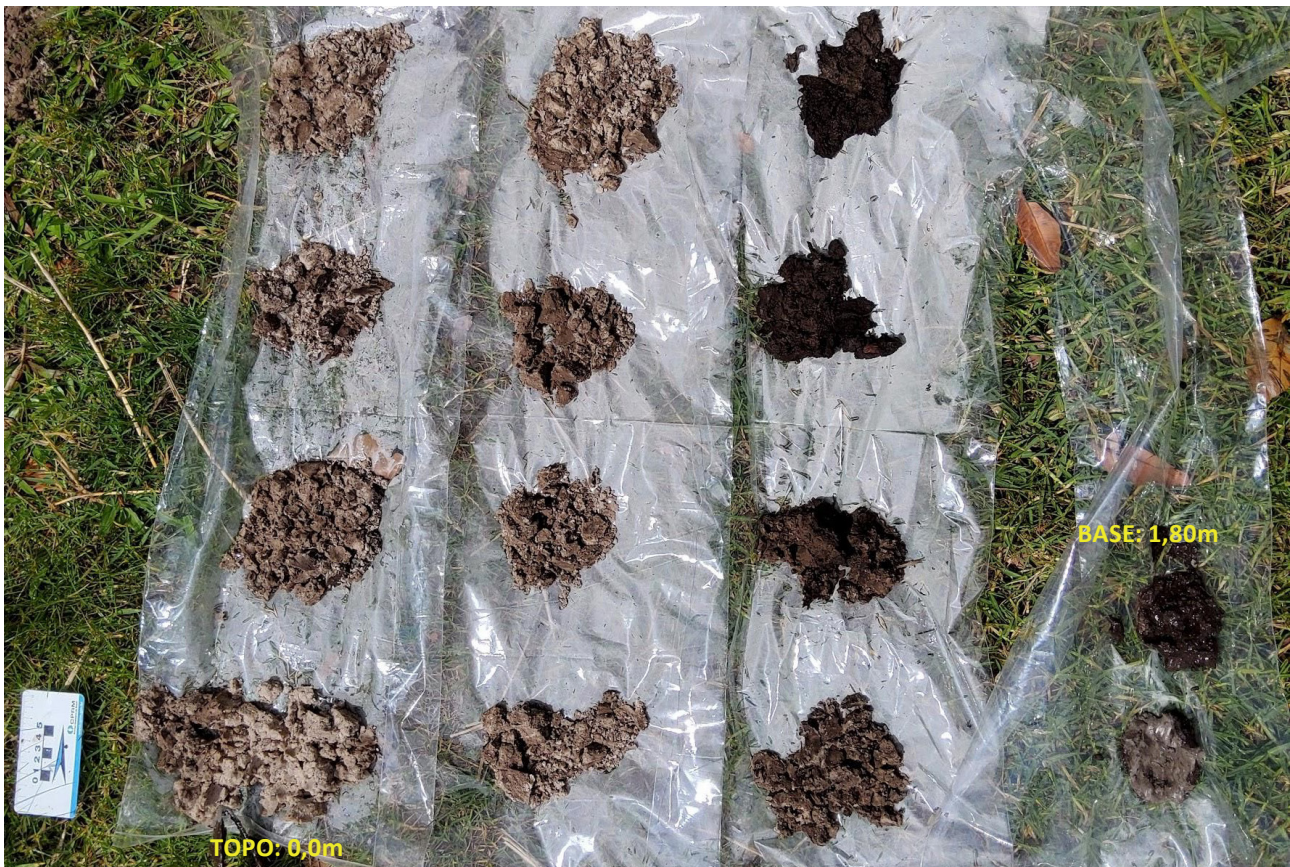
Figura 15 - Ponto campo no. 43: Amostra de trado com areia fina intercalada com argilas siltosas e/ou arenosas com detritos vegetais, com cores cinza e marrom. NA: 1,0m.
