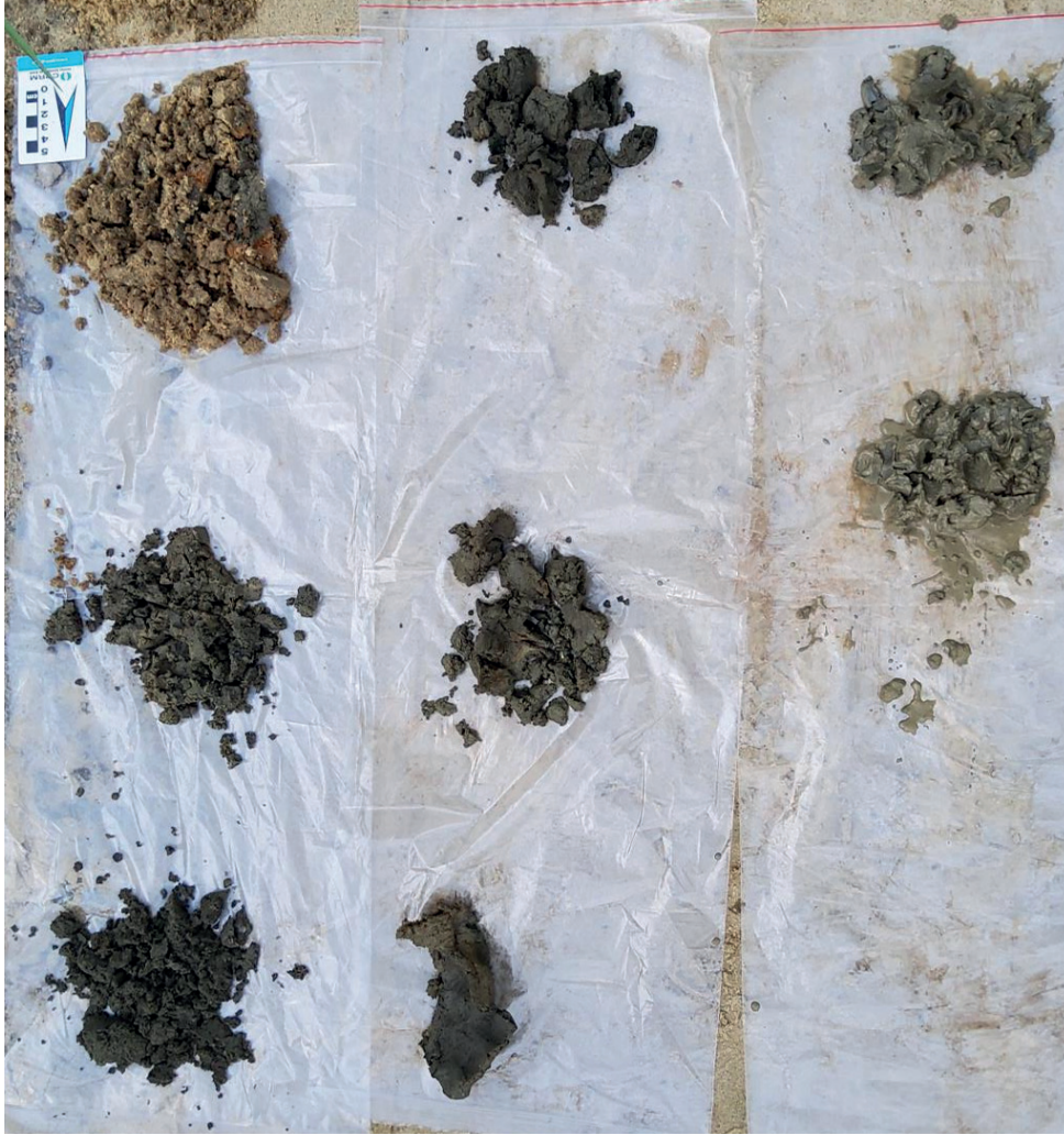
Figura 05 - Ponto 56: Amostra de sondagem a trado. Intercalação de areias argilosas e argilas arenosas sobre sedimentos lagunares. NA: 1,0m.
