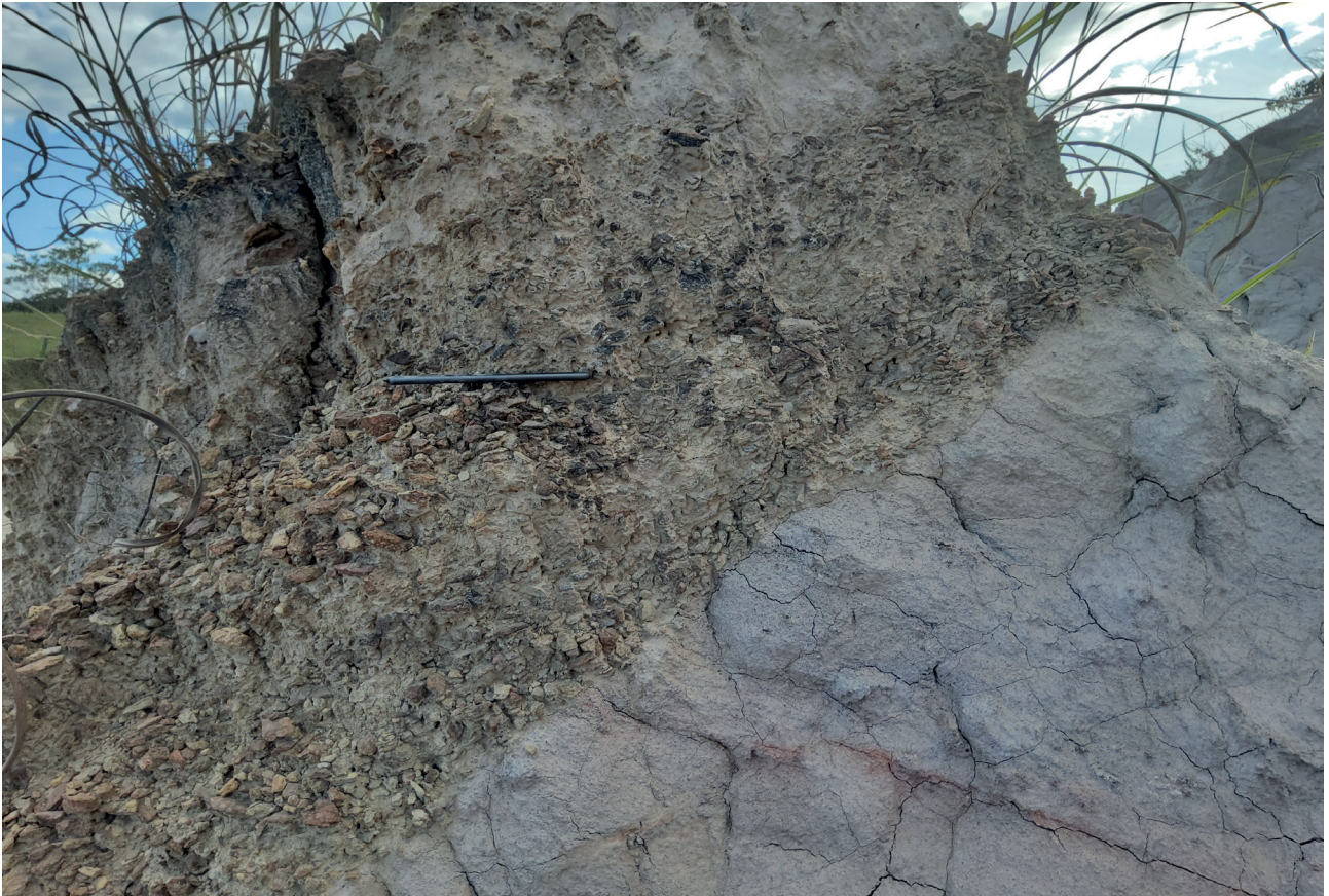
Figura 37 - Imagem exibindo depósito de colúvio, típico desta unidade, sobre substrato de xisto alterado.
