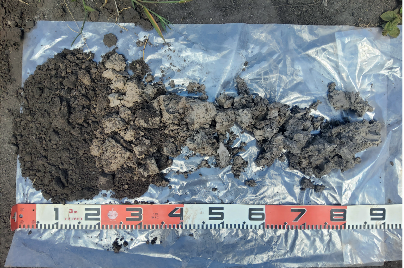
Figura 07 - Imagem de material recuperado por sondagem a trado manual exibindo sedimentos areno-argilosos típicos desta unidade.
