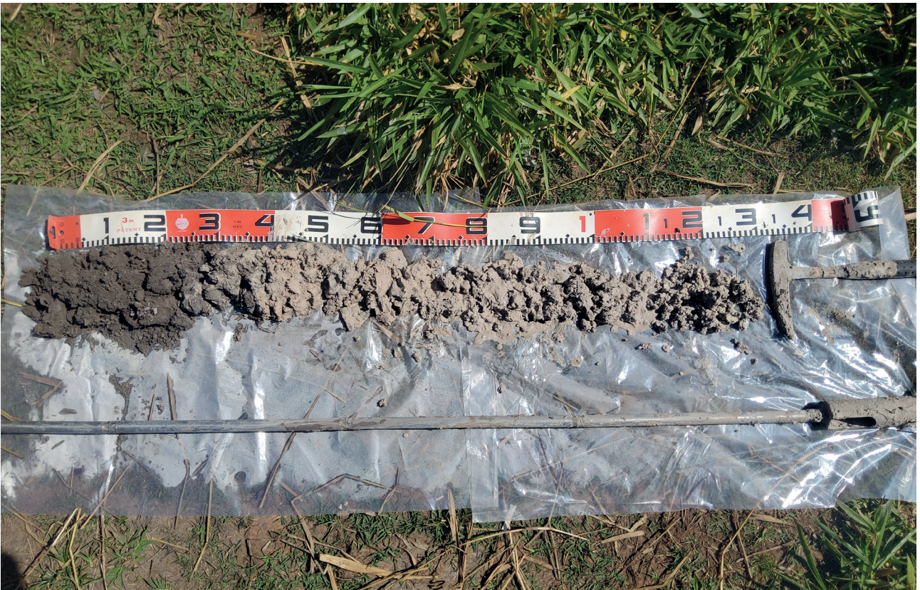
Figura 11 - Imagem exibindo material recuperado por sondagem a trado manual exibindo sedimentos areno-argilosos típicos desta unidade.
