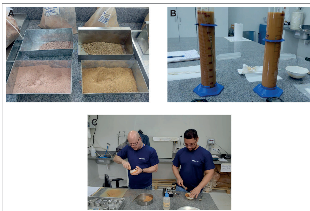
Figura 05 - Ensaios realizados: (A) Granulometria, (B) Sedimentação e (C) Limite de Liquidez e Limite de Platicidade
