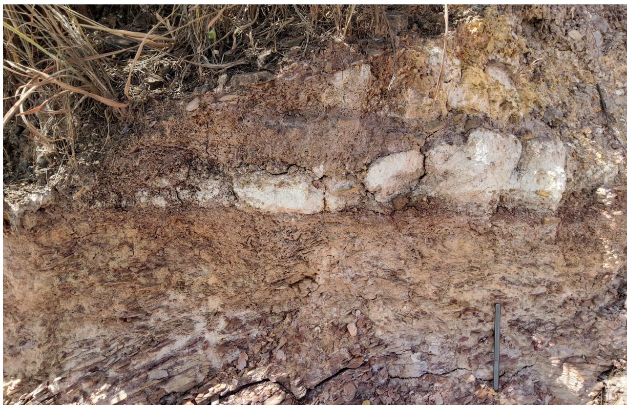
Figura 18 - Imagem de afloramento de corte, com cobertura de solo residual típica de substrato rochoso filítico, nesta unidade.
