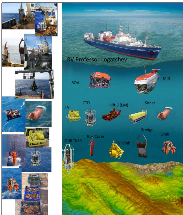
Figura 24: Principais equipamentos para o mapeamento de detalhe do leito oceânico, especialmente nas dorsais oceânicas (Petersen, 2012)
