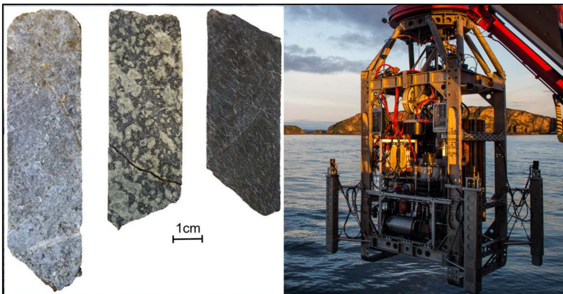
Figura 23: Equipamento para amostragens geológicas (RD2) pontuais no leito oceânico, fonte: Serviço Geológico Britânico ( https://www.bgs.ac.uk/geological-research/science-facilities/marine-operations/rd2/ ).
