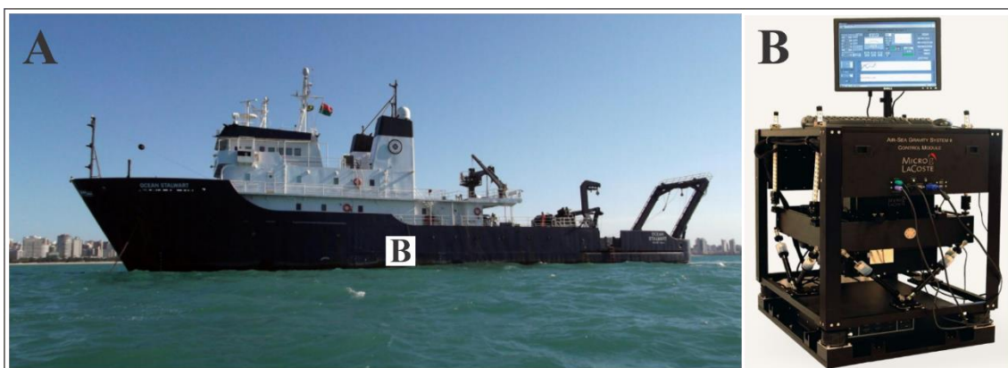
Figura 38: Gravímetro instalado a bordo do navio de pesquisa R/V Ocean Starwart. A) Figura do navio com a localização do gravímetro (quadrado branco). B) Gravímetro instalado a bordo.
