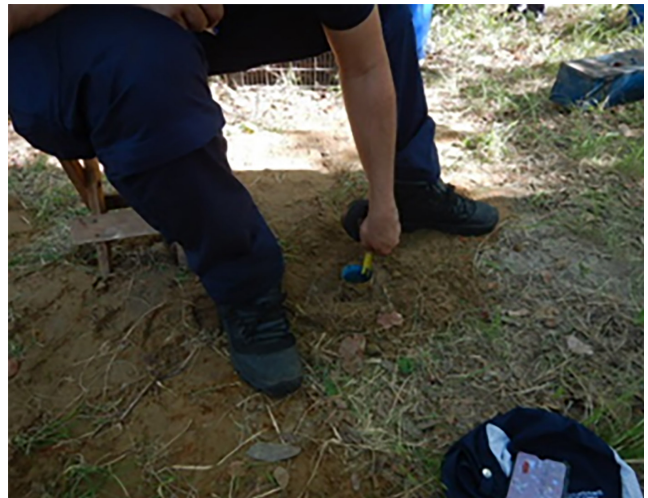
Figura 3.3 - Execução do teste de infiltração nos furos de 0,5 m, 1,0 m e 1,5 m revestidos com tubos de PVC com 75 mm de diâmetro. Fonte: elaborada pelos autores.
