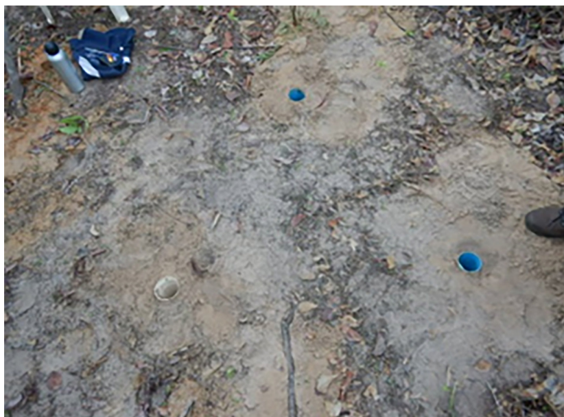
Figura 3.7 - Execução do teste de infiltração no FT-05. Foto: acervo dos autores.
