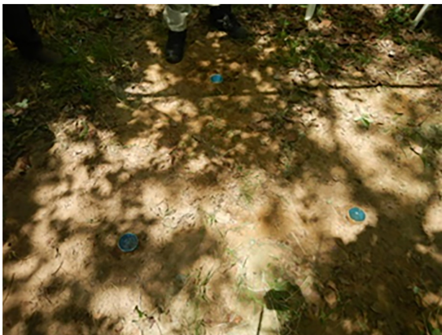
Figura 3.6 - Execução do teste de infiltração na Área 4. Foto: acervo dos autores.
