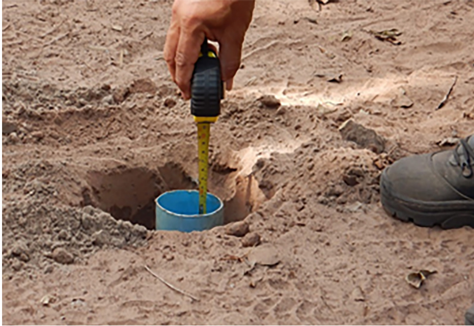
Figura 3.5 - Execução do teste de infiltração no FT-03. Foto: acervo dos autores.
