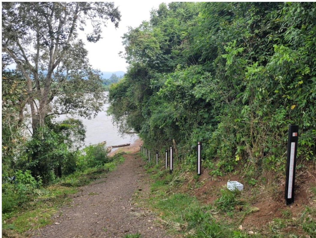
Figura 24: Instalação seção de réguas auxiliar Encantado.
