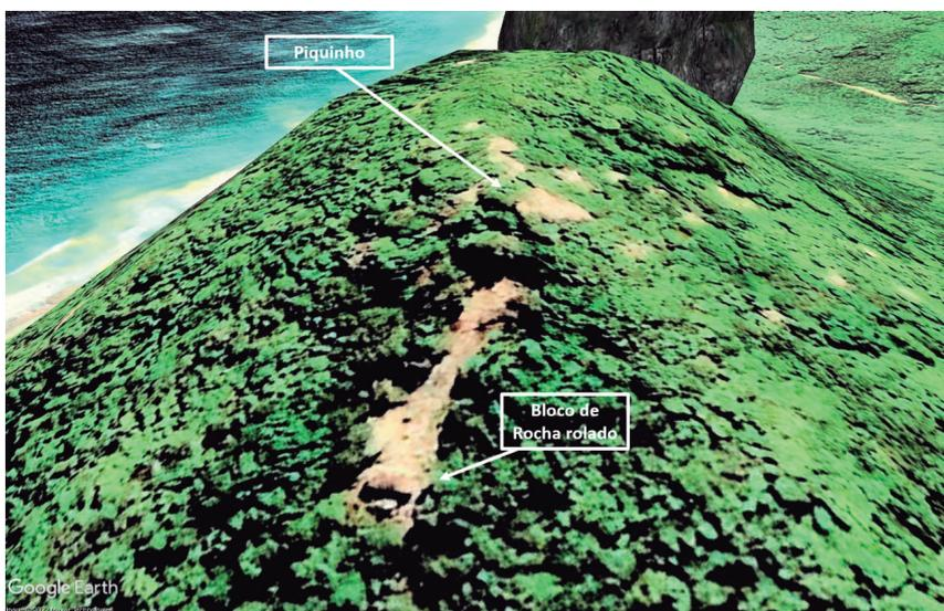
**Figura 85** - Vista da região de entorno do Piquinho mostrando bloco de rocha rolado. A destruição na vegetação é um indicativo do trajeto do bloco durante sua movimentação. Imagem: Google Earth, 2022.
