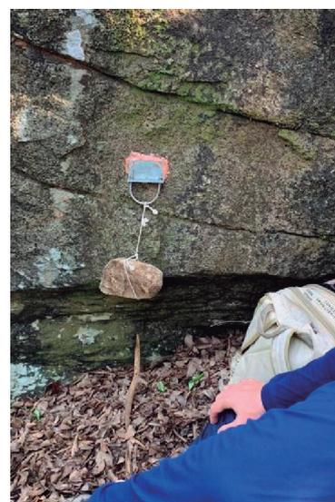
**Figura 86** - Teste de ancoragem do suporte dos sensores de movimento. Foto: Autores.
