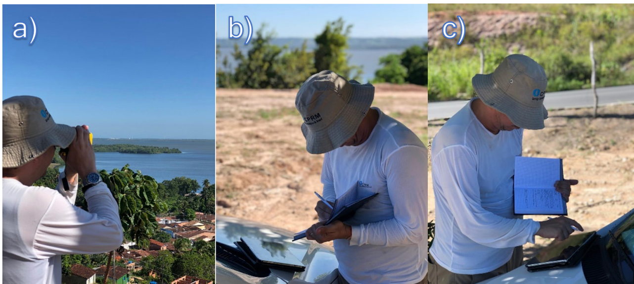
Figura 23 - Equipamento de campo: hipsômetro. Fonte: Pedro Henrique Santos.
