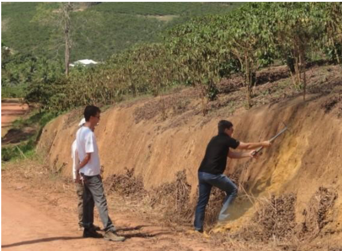
Figura 20 - Uso de martelos geológico e pedológico e enxadão para investigação em perfis. Fonte: Marcelo Dantas.
