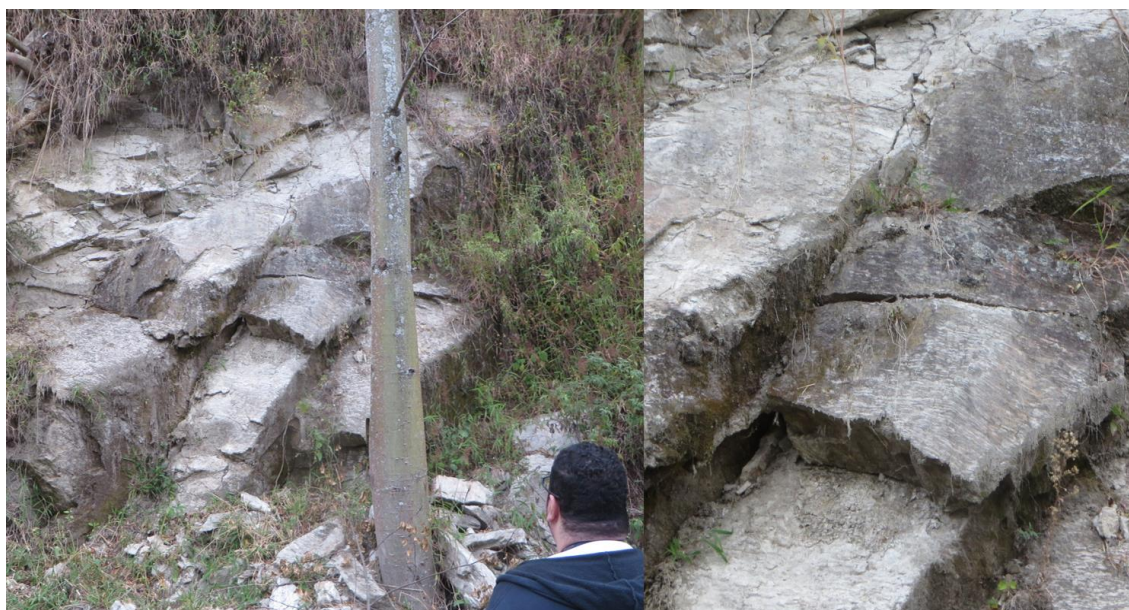
Figura 22 – Foto do talude rochoso no ponto P-3, a montante do acesso ao OPD. Notar fraturamento sub-paralelo à foliação gnáissica (foto da direita) e que intercepta duas outras direções de fraturamento aproximadamente perpendiculares entre si, uma sub-vertical e outra com mergulho aproximado de 45 graus desconfinada pela linha do corte.
