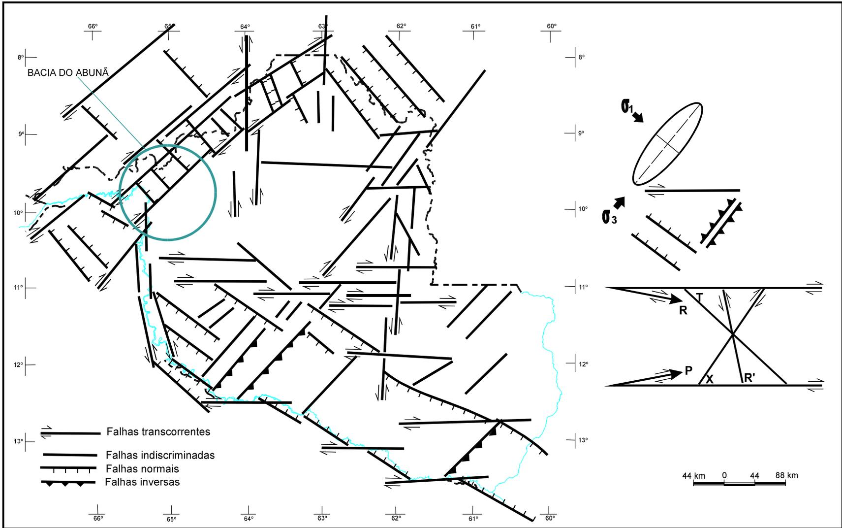
Figura 2.37 – Quadro tectônico proposto para o Pleistoceno Superior / Recente, principais estruturas geradas e campo tensional
