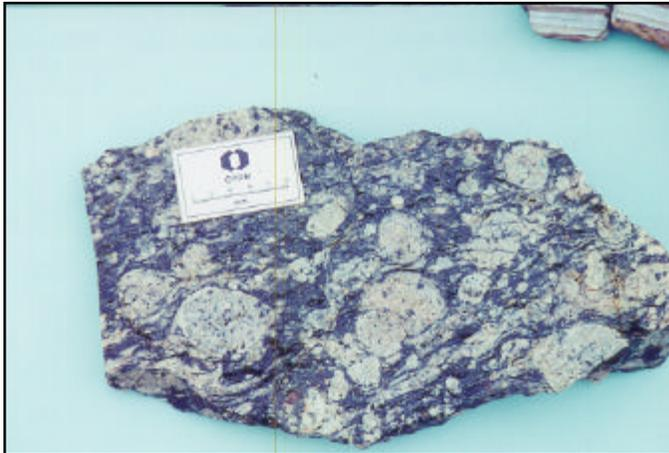
**Foto 37** – Granito viborgítico da Suíte Intrusiva Serra da Providência mostrando feições indicativas de deformação desenvolvida em condições dúcteis/rúpteis. Região de Machadinho d'Oeste.
