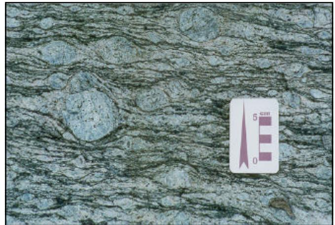
**Foto 20** – Detalhe do augen gnaiss da foto anterior onde porfiroclastos de k-feldspato rotacionados e achatados mostram "caudas" de baixa assimetria. Mesmo ponto da foto 19.
