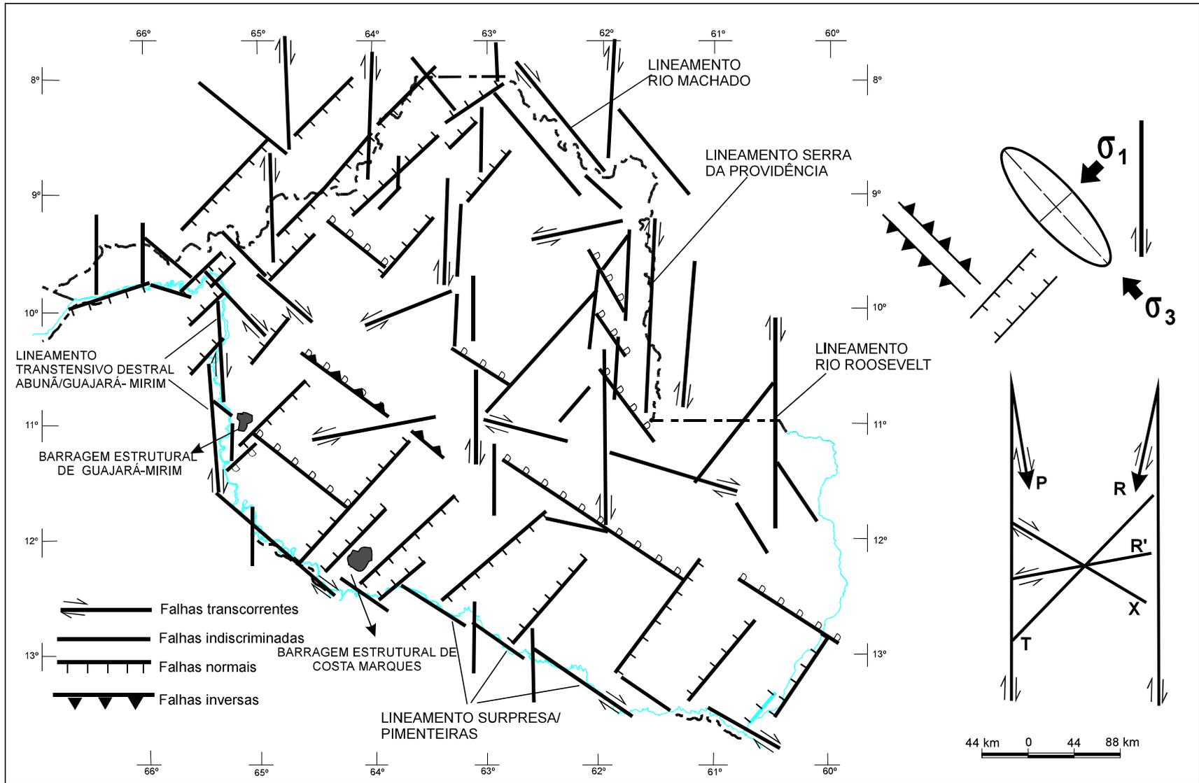
Figura 2.36 – Quadro tectônico proposto para o Mioceno/Plioceno, principais estruturas geradas e campo tensional admitido para a região do estado de Rondônia (Scandolara, 1998, no prelo).
