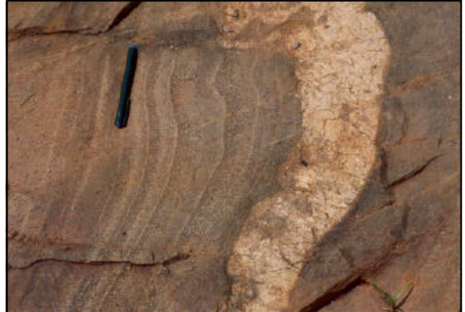
**Foto 42** – Biotita gnaïsse mostrando divisões de Bouma amalgamadas (arenitos+siltitos+pelitos). Notar veio quartzo-feldspático neoformado relacionado à deformação  $D_1$  e foliação plano-axial incipiente relacionada à fase  $D_2$ . Seqüência Metavulcano-Sedimentar Nova Brasilândia, balneário L-138, Nova Brasilândia d'Oeste.
