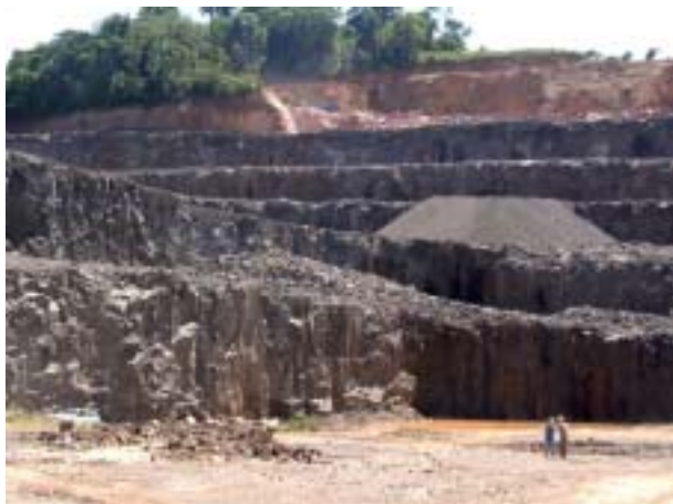
Frete da pedreira INCOPEL onde o primeiro derrame repousa sobre a superfície de stoos de uma zona de Botucatu. Acima e ao fundo nível eólico intertrápico.
