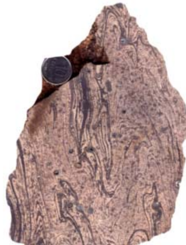
Detalhe das dobras de fluxo assimétricas.
