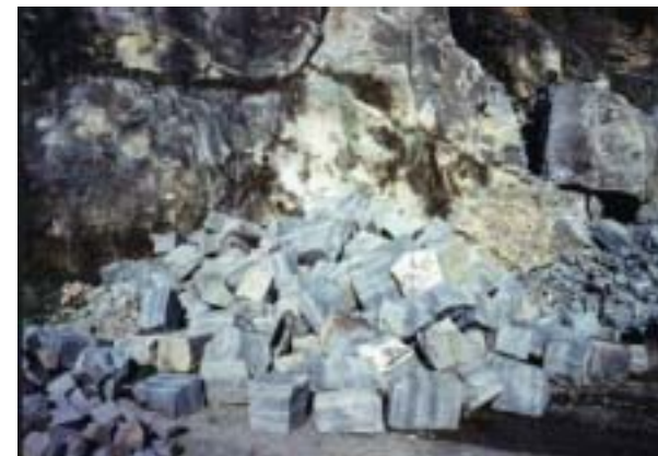
Pedreira de rocha vulcânica para a retirada de blocos para construção.
