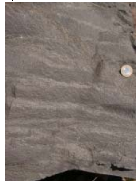
Detalhe no afloramento da foto anterior, mostrando o início da nucleação da disjunção tabular posicionada próximo ao topo dos derrames.
