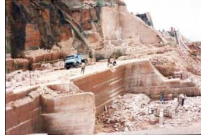
Pedreira de arenito com exploração de lajes para pisos.
