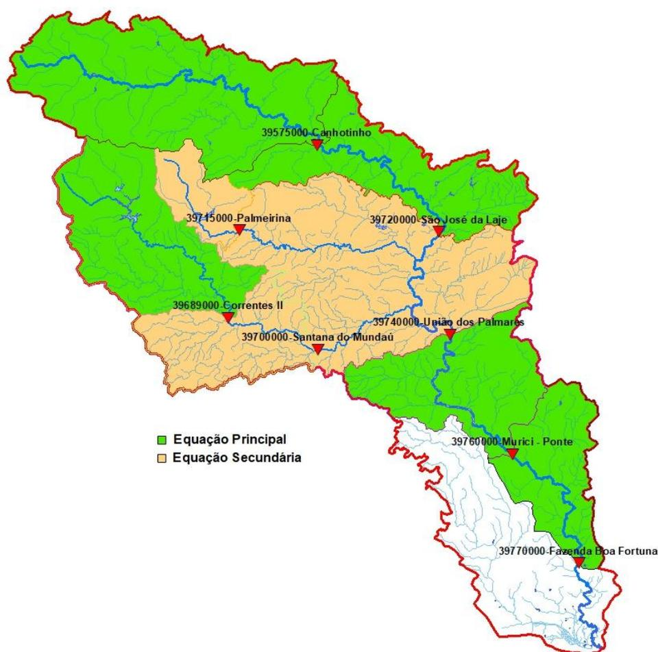
Figura 5.4.1 – Regiões definidas para aplicação das equações de regressão na estimativa da média das vazões máximas anuais, desde que atenda à condição mínima de monitoramento fluviométrico.
