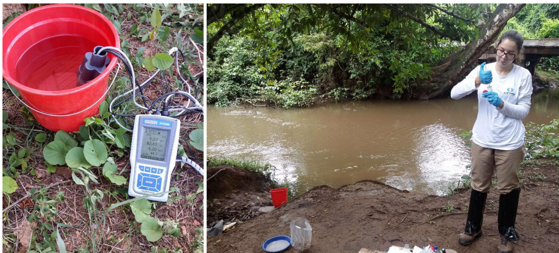
Figura 3: Medição de parâmetros físico-químicos de amostra de água (esquerda) e filtragem da amostra e exemplo de ponto de coleta de água superficial e sedimento (direita). Fotos: arquivo do projeto.
