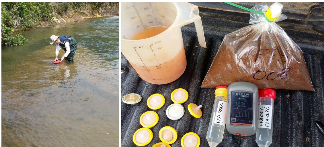
Figura 4: Peneiramento da amostra de sedimento em campo (esquerda) e amostras de água e sedimento já coletadas e prontas para o armazenamento (direita). Fotos: arquivo do projeto.
