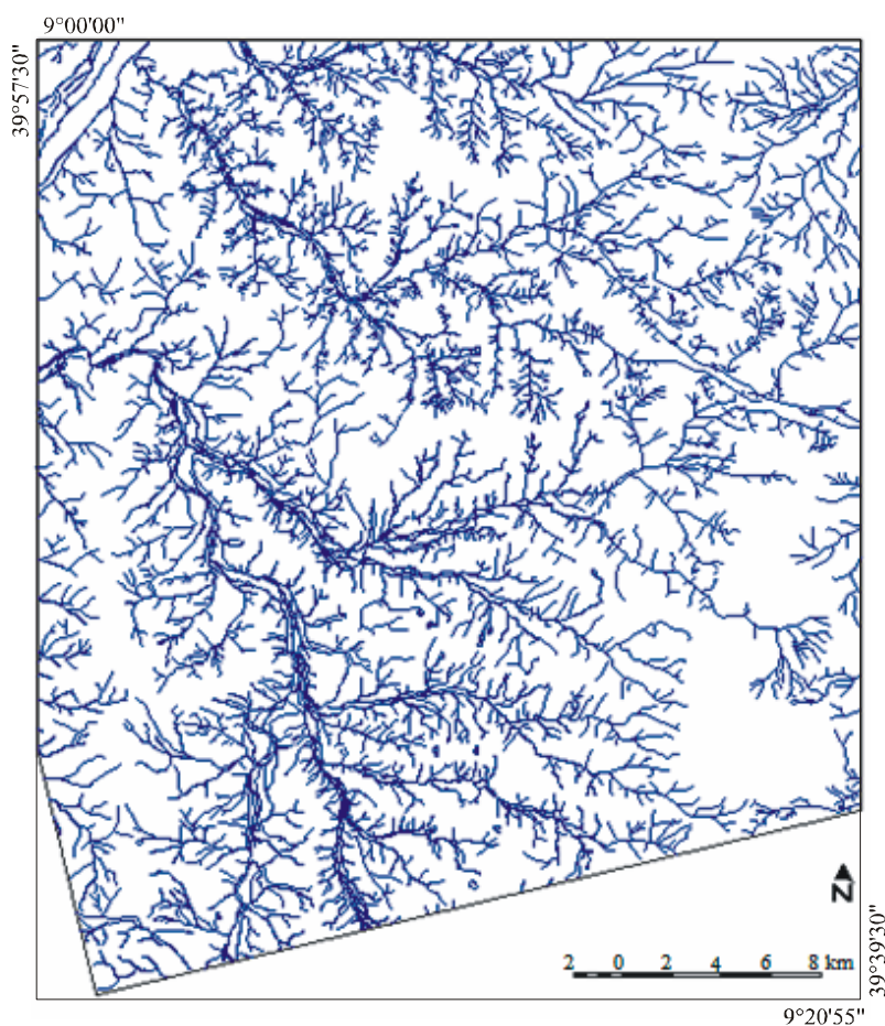
Figura 6-2 – Rede de drenagem extraída a partir da imagem RADARSAT-1 (F2A) e do mapa geológico de Delgado e Souza (1975).
