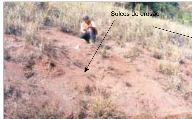
Fotos 77 e 78 - Cicatrizes de erosão formadas pela concentração de águas pluviais sobre solos residuais portadores de argilominerais expansivos.
