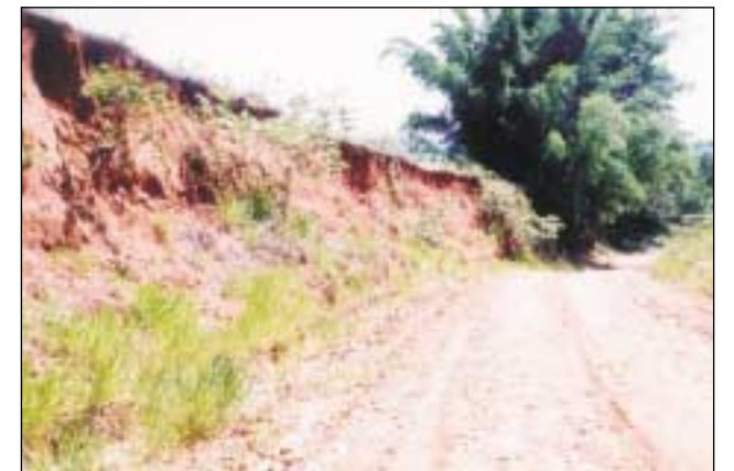
Foto 8 - Solos areno-siltosos derivados da alteração de sedimentos do Grupo Bauru - Formação Adamantina.
