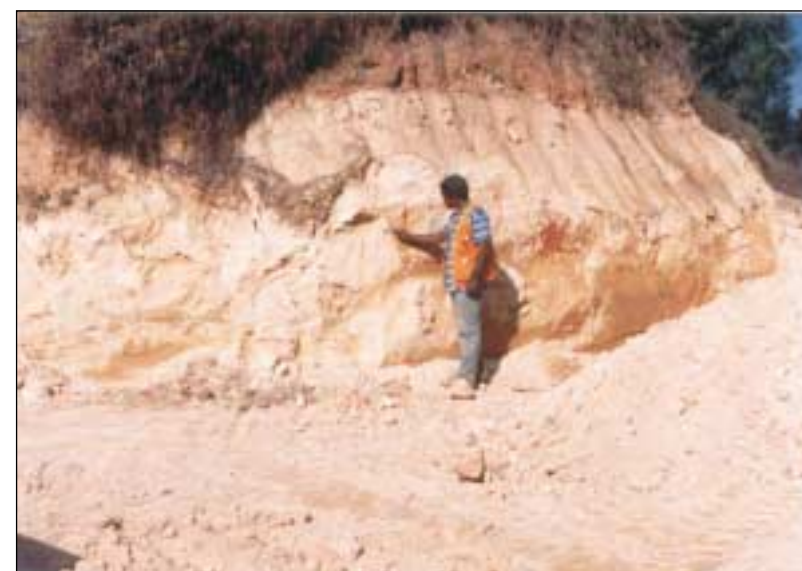
Foto 106 - Material de alteração de um dos tipos de rochas granitóides que ocorrem nos terrenos diferenciados como subdomínio 10F. Trata-se de uma rocha pobre em minerais máficos e rica em feldspato e quartzo. Em função dessa composição, quando parcialmente intemperizadas, constituem-se num bom material de empréstimo. Por outro lado, é muito erosiva quando exposta em taludes de corte e em obras terraplenadas e os solos delas derivados são de péssimas características agrícolas. Variações litológicas como dessas rochas fazem com que o domínio 10 apresente muitas particularidades setorizadas, importantes de serem consideradas no processo de uso e ocupação. Por isso, tais variações serviram de parâmetros para dividir o domínio 10 em vários subdomínios.
