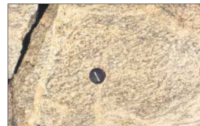
Foto 1 - Exemplar de uma rocha granito-gnáissica, tipo bastante comum nos terrenos diferenciados como domínio 10. Pode-se observar que os minerais encontram-se achatados e orientados. Isso se deve às deformações que sofreram em função de processos tectônicos compressivos de baixo ângulo e em estado dúctil (plástico).
