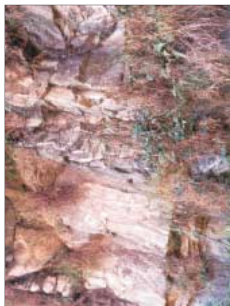
Fotos 98 e 99 - Exemplo de alguns tipos de rochas que sustentam os terrenos diferenciados como domínio 10. Em função do bandamento composicional e textural, essas rochas apresentam comportamento geotécnico extremamente heterogêneo, heterogeneidade essa que se reflete tanto local como regionalmente.
