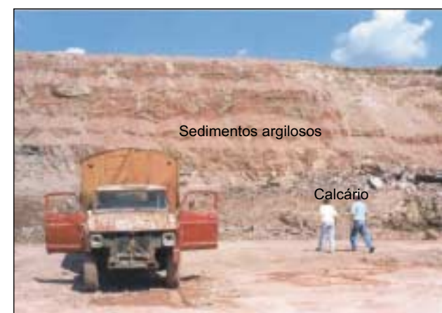
Foto 76 - Frente de lavra de calcário dolomítico associado à Formação Corumbataí explorado para corretivo de solos. A presença dessas rochas indica que os sedimentos do domínio 7 se depositaram em um ambiente marinho, próximo à linha de costa.
