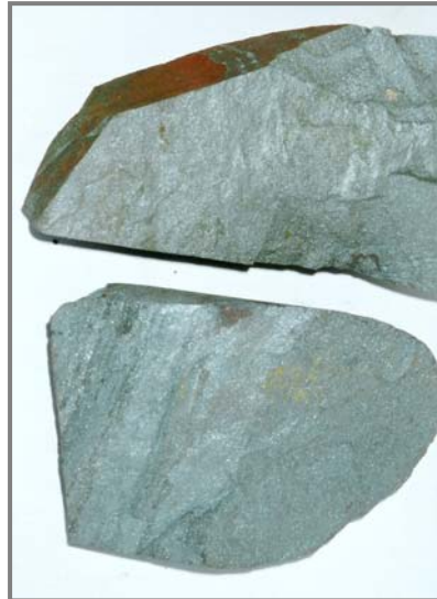
Figura 5.7 - Hematita compacta bandada, mina Capitão do Mato, furo CMT 09/92.
