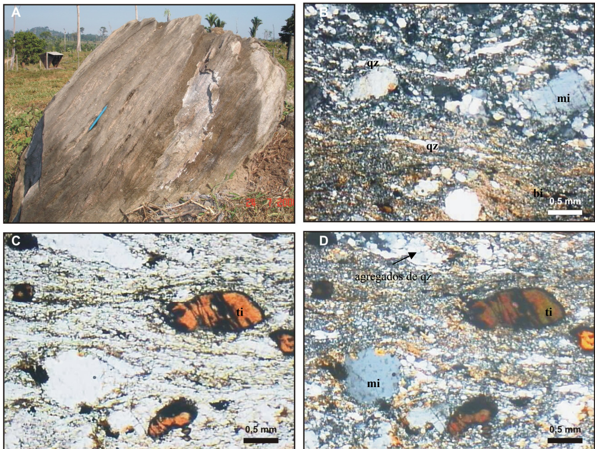
Figura 5.7. Aspectos macro e microscópico do titanita-biotita monzogranito (a) foliação milonítica (b) Aspecto da foliação milonítica marcada por fitas de quartzo e caudas de neoblastos (quartzo, feldspato, biotita em grãos de 0,02mm); (c) e (d) Porfiroclastos sigmodais de titanita impregnados de minerais opacos e microclina.
