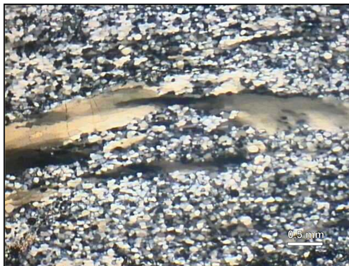
Figura 4.21. Fotomicrografia (luz polarizada) quartzito ultramilonítico mostrando cristais de quartzo fitados fortemente recristalizados com subgrãos e novos grãos. Afloramento CC-54.
