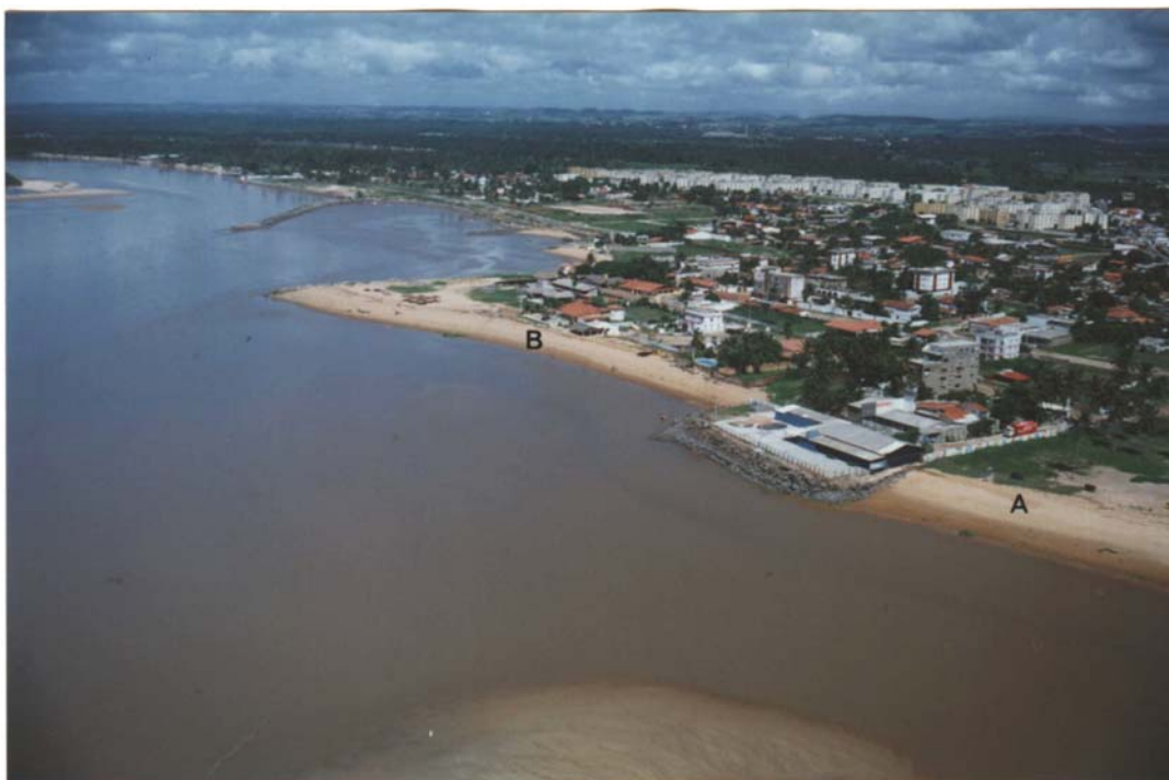
Foto 23 – Vista aérea da Célula 7, podendo-se observar o estuário da Barra das Jangadas e, em primeiro plano, próximo ao perfil P6 (A), o impacto provocado pela construção inadequada de um restaurante avançando sobre o estirâncio, reduzindo o aporte de sedimentos a sul do mesmo e conseqüente recuo da linha de costa (B).
