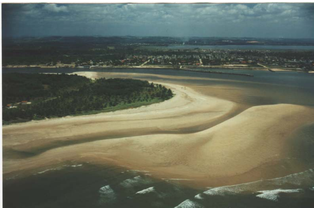
Foto 25 – Vista aérea do final da Célula 7, destacando-se, em primeiro plano, uma sedimentação na praia do Paiva; o guia corrente construído na margem esquerda do estuário da Barra das Jangadas (centro); e a Lagoa Olho d'Água (ao fundo).
