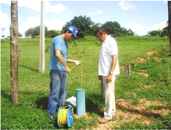
B = Medição do nível estático em poço tubular - Juazeiro do Norte/CE
