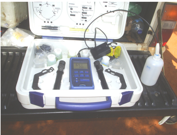
C = Kit de fabricação alemã utilizado em campo para medida de pH, temperatura e condutividade elétrica (modelo MULTI 340i/SET marca WTW Wissenschaftlich-Technische Werkstätten)
