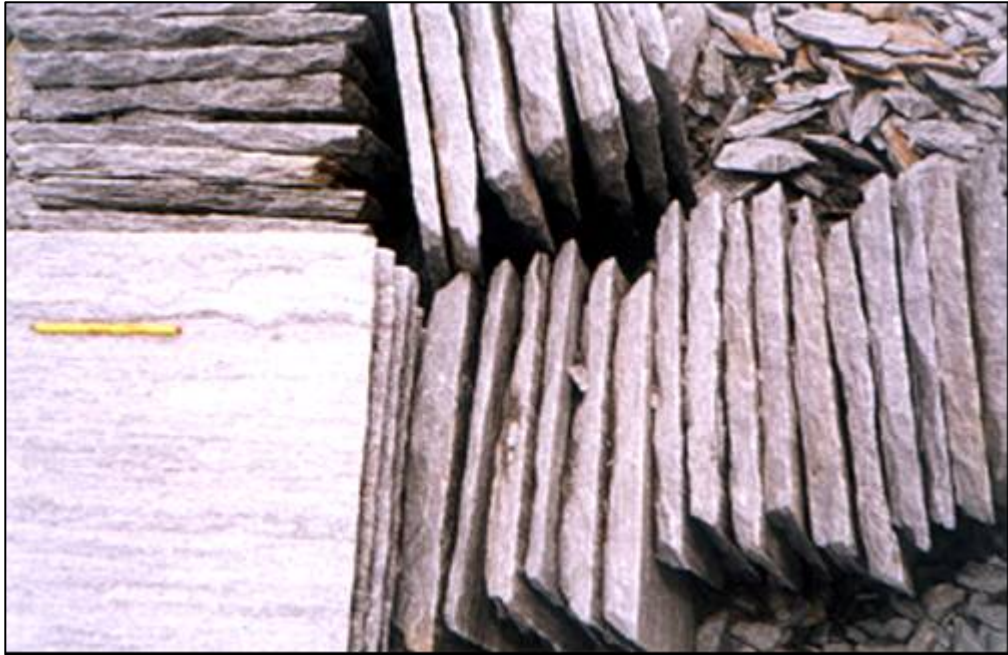
FOTOGRAFIA 31: Fácies micáceo do ortogneisse “Rachinha” Cariris Velhos, cortado em placas, para sua utilização em revestimento. Ponto de venda na BR-230, próximo ao ESP-131.
