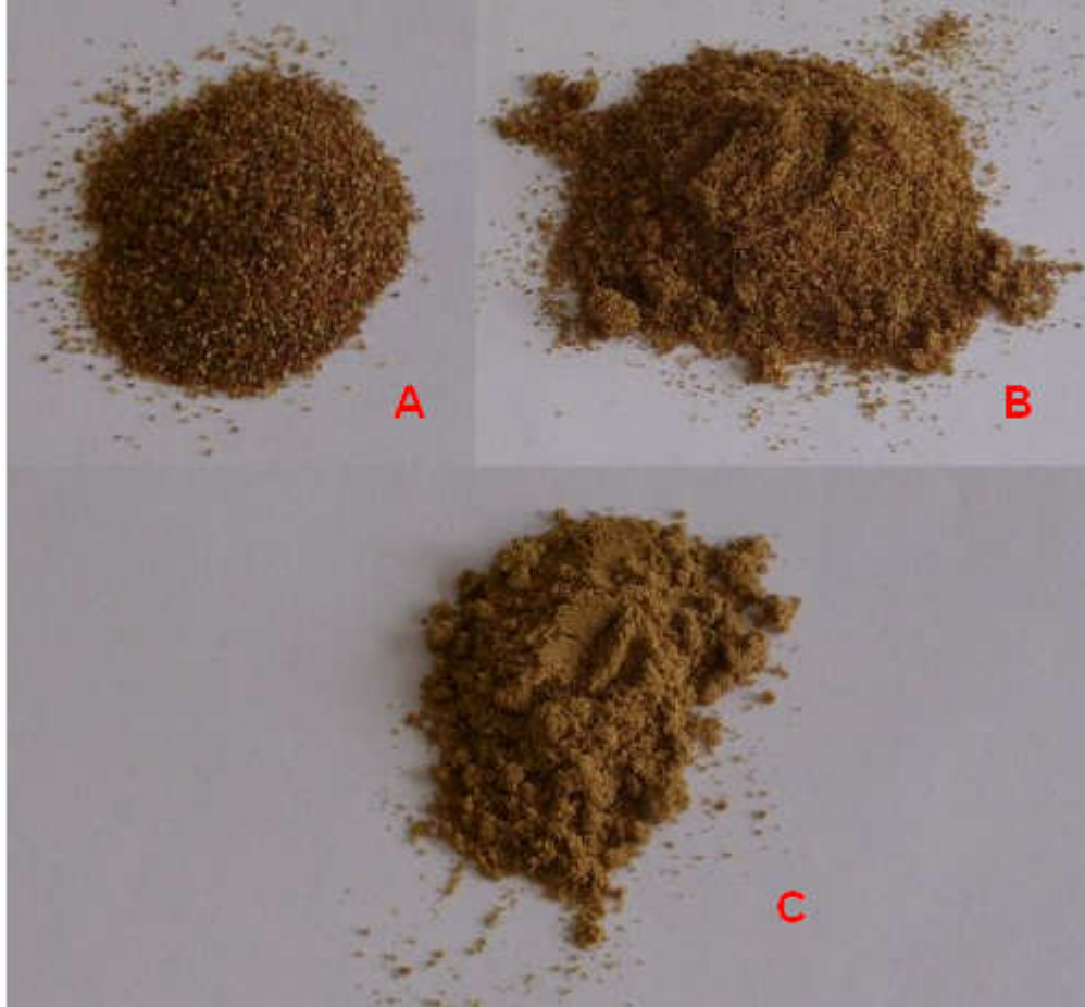
Figura 19: Diferentes tamanhos de partícula de uma mesma amostra de ração para cães, onde: A. partículas maiores que 0,50 mm; B. partículas com tamanho entre 0,50 e 0,35 mm e C. partículas menores que 0,35 mm.
