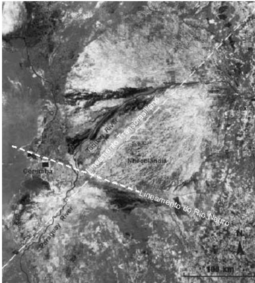
Figura 4.5 – Lineamento Transbrasiliiano e Lineamento do Rio Negro. Observar o rio Paraguai sendo aparentemente capturado pela extensão destes dois lineamentos (modificado de Assine, 2004).
