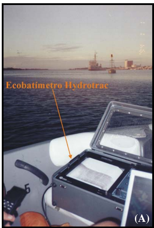
Figura 2.4 - A) Ecobatímetro modelo HYDROTRAC da Odom , operando na frequência de 200 kHz e B) Antena do DGPS Starlink acoplado ao HYDROTRAC (Fotos: Frazão, set. 2001).
