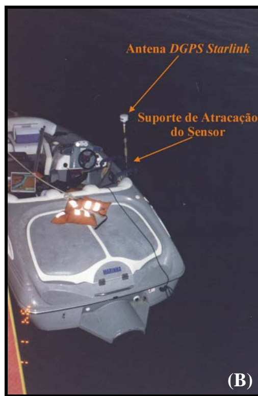
Figura 2.4 - A) Ecobatímetro modelo HYDROTRAC da Odom , operando na frequência de 200 kHz e B) Antena do DGPS Starlink acoplado ao HYDROTRAC (Fotos: Frazão, set. 2001).
