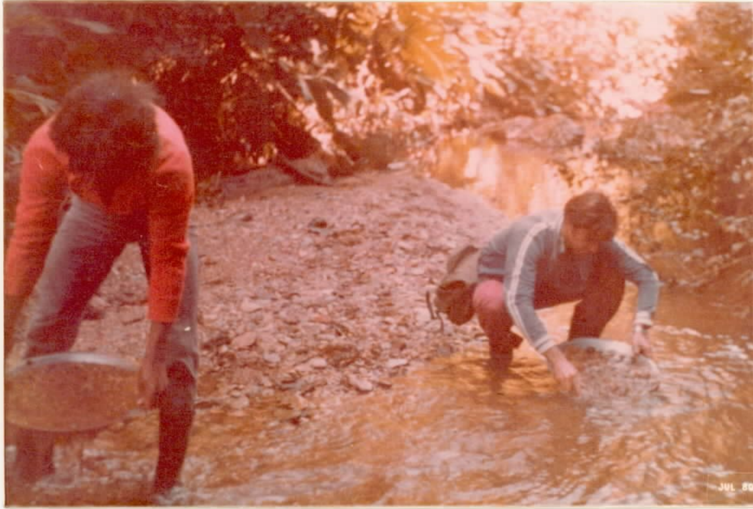
FOTO 23 - Coleta de concentrados de batéia .
