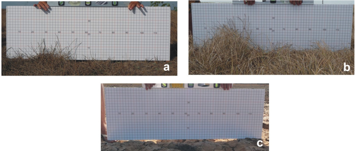
Figura 6.3 – Rugosímetro utilizado em campo para a obtenção dos parâmetros de microtopografia: a) nos campos inundáveis; b) nos campos pastejados; c) nos campos salinos.
