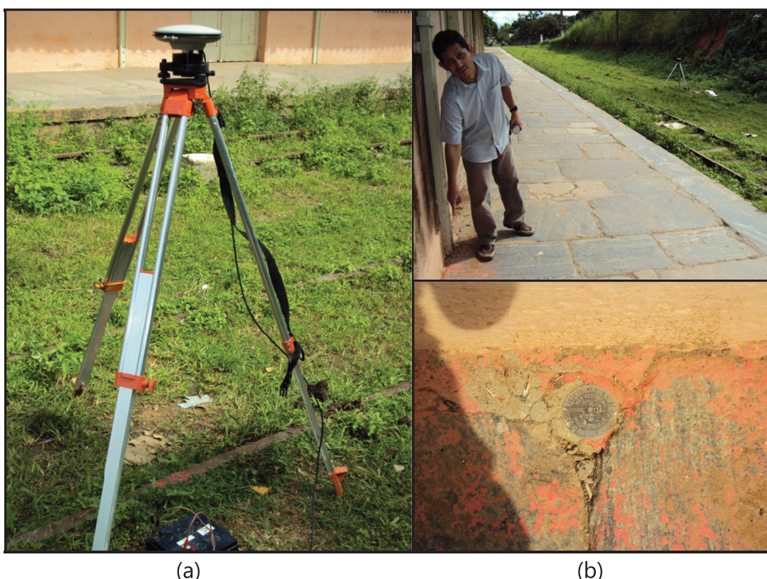
Figura 33 – (a) RN Trilho utilizada como base do levantamento. Fonte: Autor. (b) RN 384K de Rede Altimétrica Brasileira do IBGE. Fonte: Autor.
