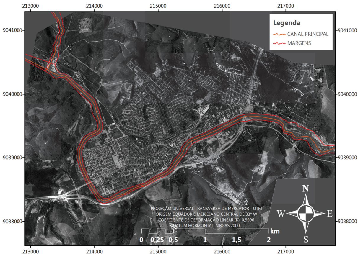
Figura 48 – Delineamento das margens e eixo do rio a partir das ortofotos digitais.
