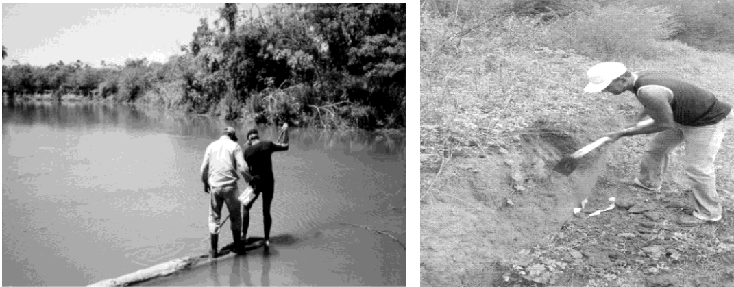
Figura 4: Amostragem de sedimento de corrente (esq.); amostragem de solos em barranco de estrada, após a limpeza com enxadão utilizar pá ou colher de plástico para efetuar a coleta (dir.).
