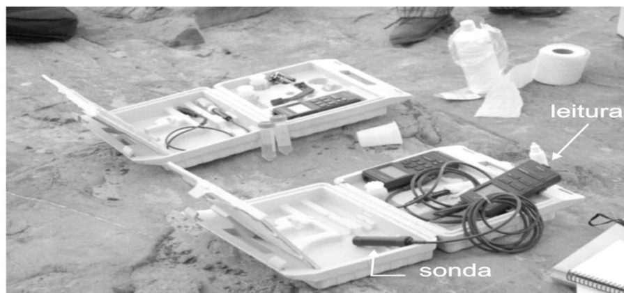
Figura 3: Equipamentos utilizados para leitura dos parâmetros de pH, OD, temperatura e condutividade.
