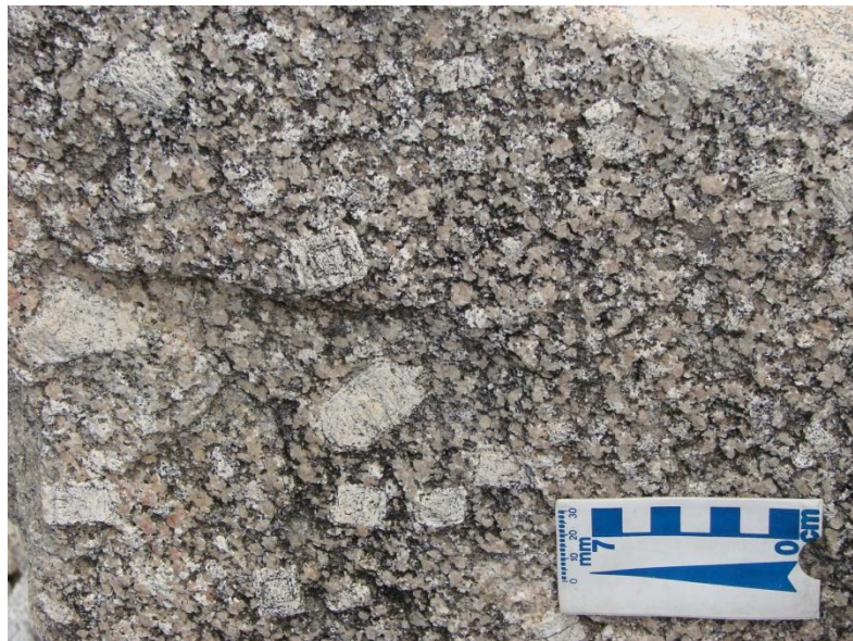
Figura 6 – Detalhe do granito Quati, com fenocristais zonados em matriz constituída por quartzo, feldspato e biotita.
