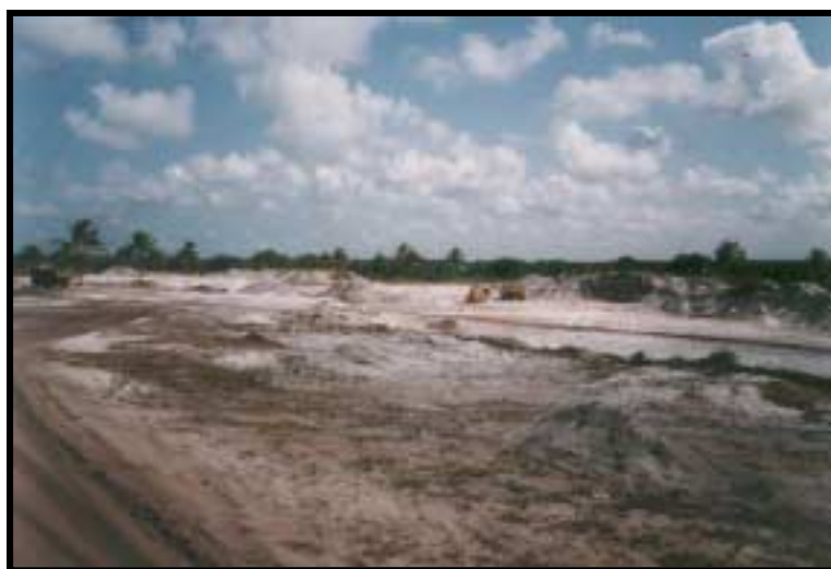
Foto 10 - Lavra de areia em terraço marinho - BR 101 Sul, município de Jaboatão dos Guararapes
