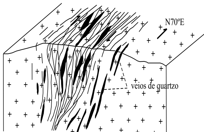
Figura 4.8b – Esquema interpretativo da figura 4.8a, mostrando a geometria em flor positiva desenvolvida por transpressão (segundo Santos, 1998).
