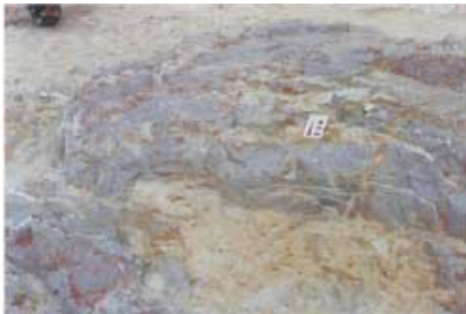
Figura 4.11 – Brecha vulcânica/hidrotermal com adulária, contendo veios de sílica amorfa, calcedônia e quartzo. Garimpo Bandeirantes (estação MA-99).
