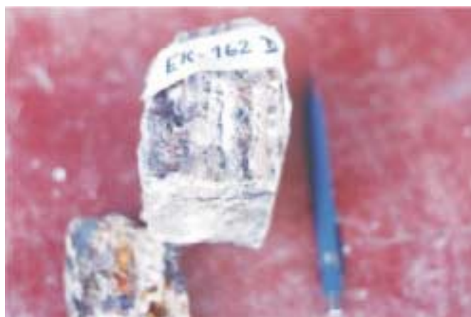
Figura 4.3 – Detalhe de veio aurífero, mostrando seu aspecto laminado. Observar as diferentes texturas nas várias lâminas (maciça, pente, preenchimento de vazios, rocha hidrotermalizada). Garimpo Água Branca (estação EK-162).
