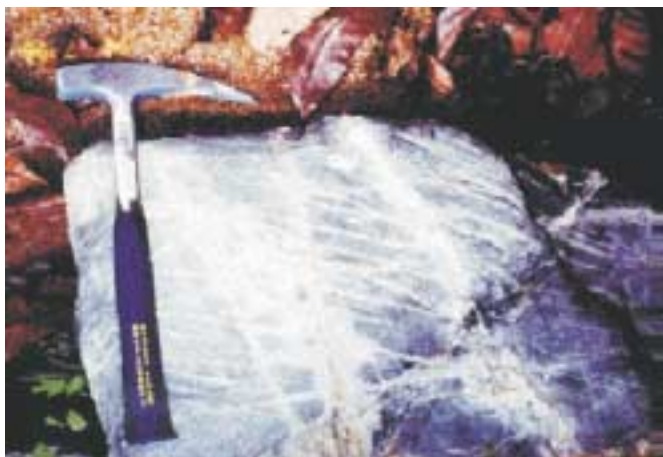
Figura 4.14 – Sistema de veios stockwork cortando andesitos hidrotermalizados da Formação Bom Jardim. Garimpo Maranhense (estação MA-02).
