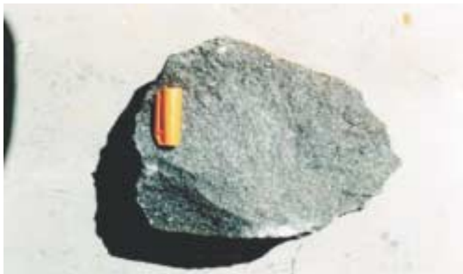
Figura 2.18 – Diabásio microgranular dos diques do Diabásio Crepori da área-tipo da unidade. Rio Crepori, estação MQ-62 na Folha Caracol.
