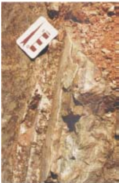
Figura 4.5 – Veio aurífero mostrando evidências de várias fases de preenchimento (crack and seal). Garimpo Santa Isabel (estação EK-128).
