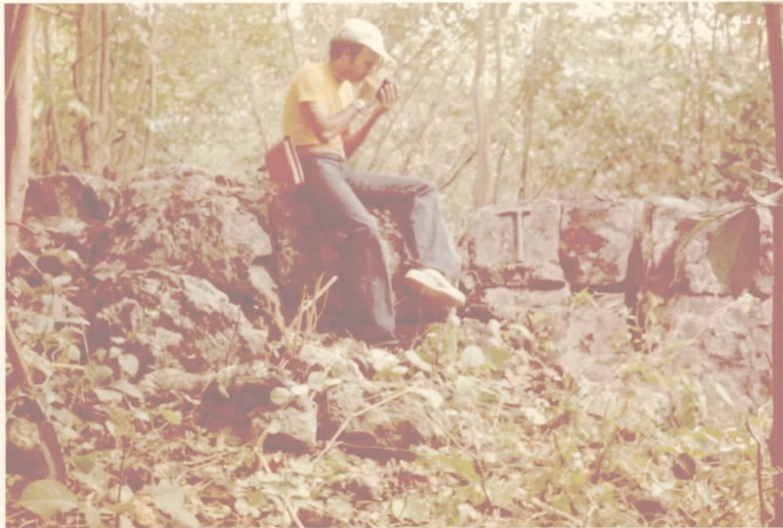
FOTO 10- Afloramento de minério de manganês compacto e bastante fraturado. Note-se o intenso fraturamento transversal. Ocorrência do Alto Urubu, distrito de Curupira, mun. de Aracoiaba.
