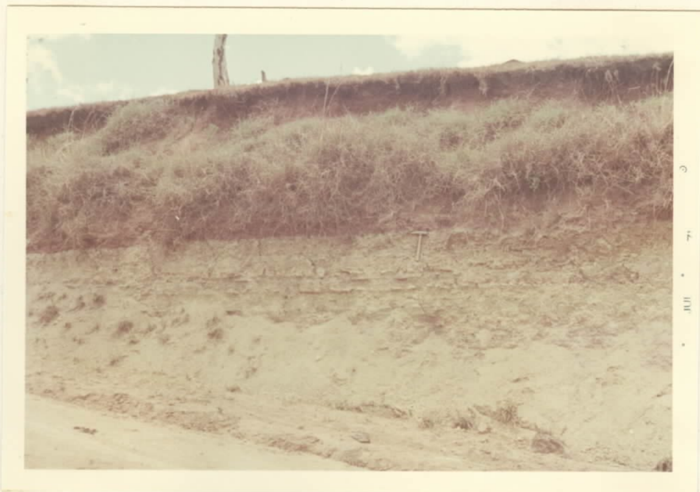
FOTO 11 - FOLHELHOS creme-amarelados sotopostos a siltitos e argilitos avermelhados; no t o po ocorre camada de folhelho betuminoso. O pacote todo pertence à Formação Quiricó e atinge, no local, 10 metros de espessura. Estrada Tiros - Quintinos, Mun. de Carmo do Paranaíba.
