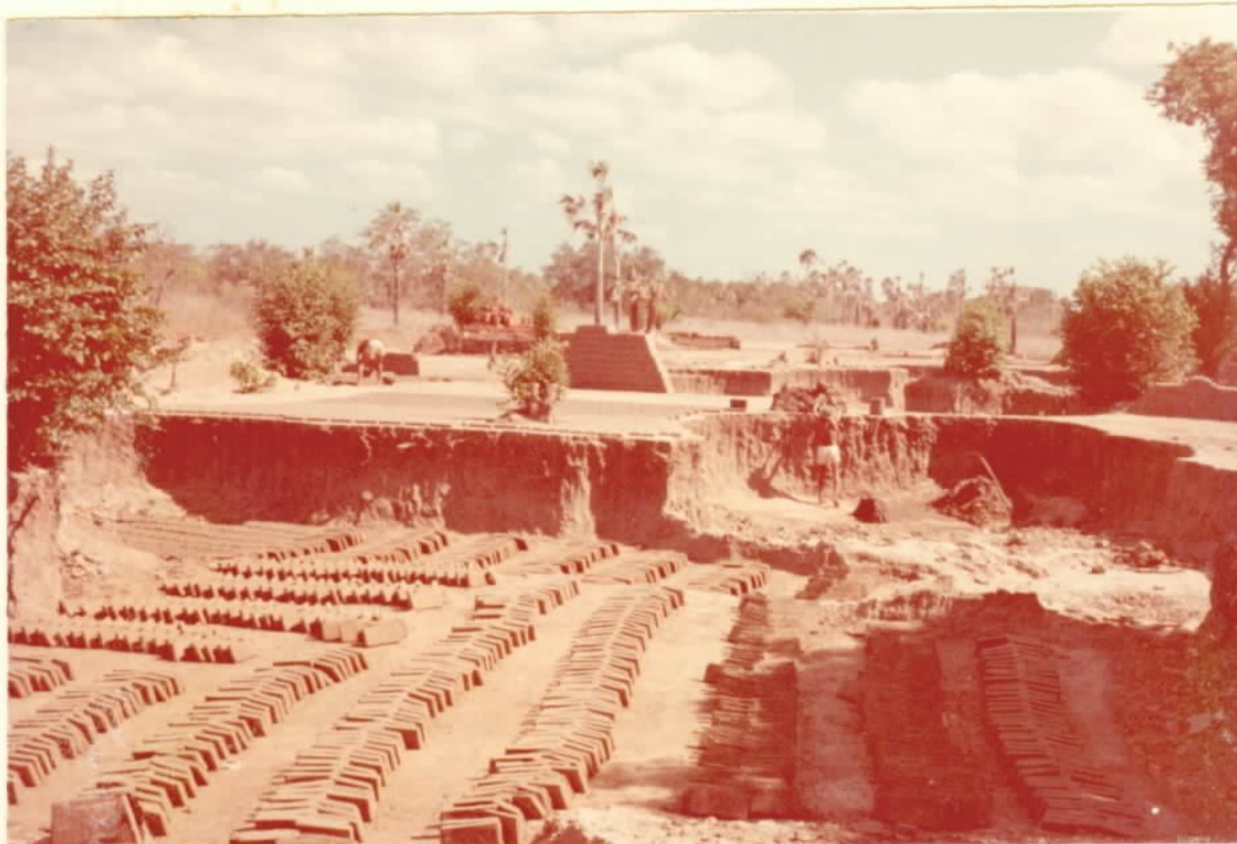
Foto 42 - Frente de lavra do depósito argiloso do rio Aca ra ú; no primeiro plano, tijolos moldados expostos ao sol para secar. Garimpo João Bandeira, Sobral, Ceará.
