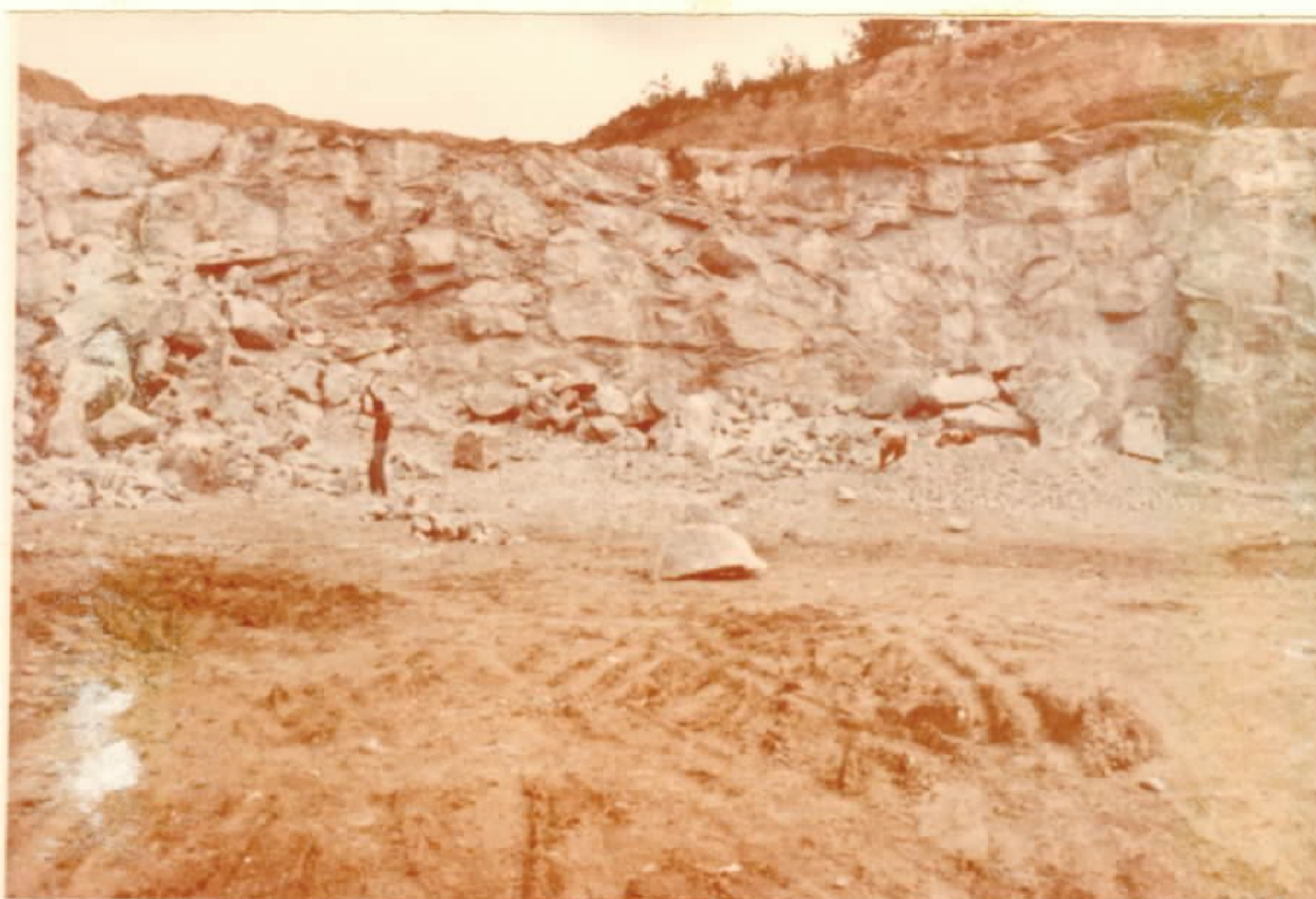
Foto 19 - Frente de lavra de gipsita (camada com 10m de espessura); note-se que o capeamento foi removido. Mina Pedra Branca 2, mun. Santana do Cariri, Ceará.
