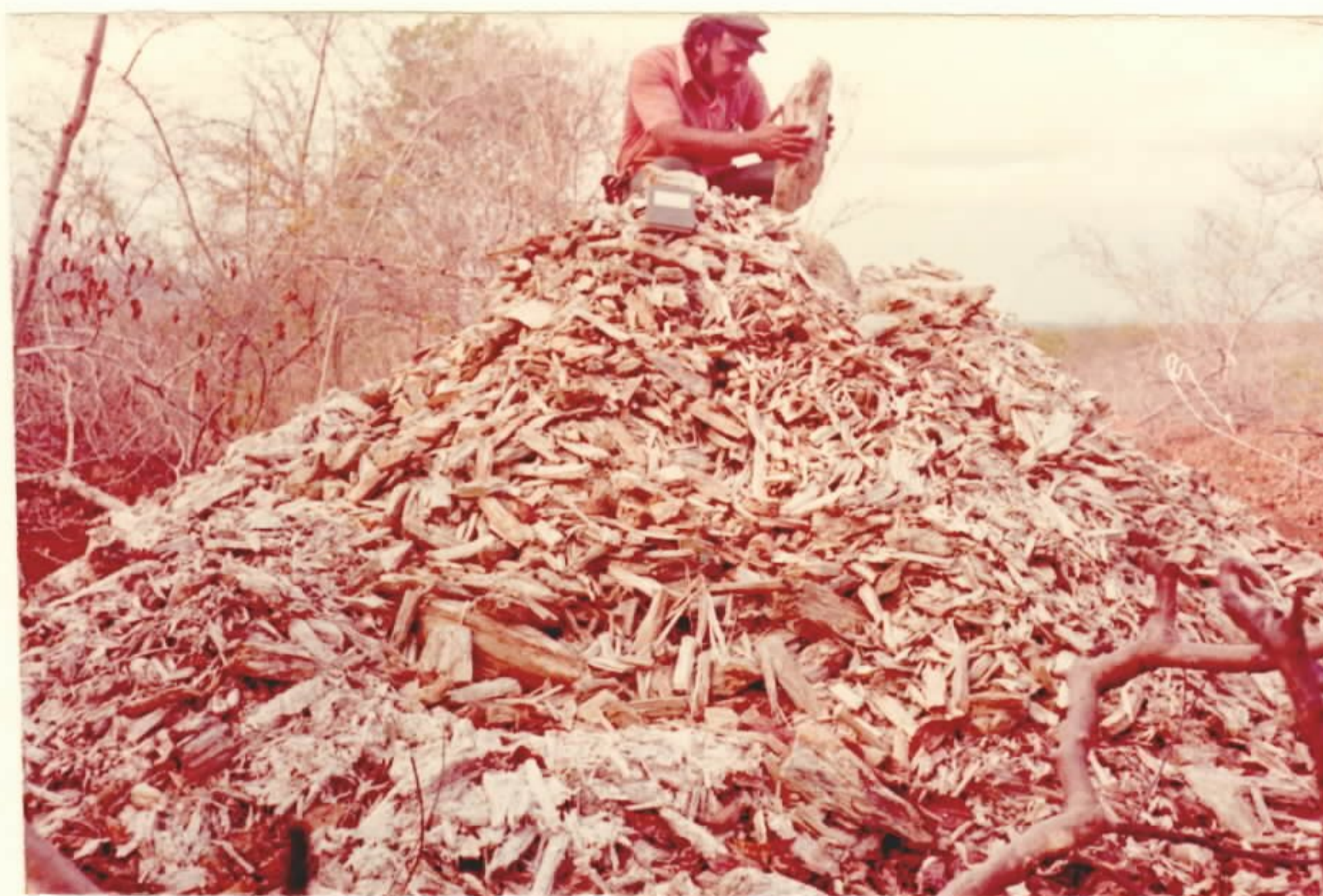
Foto 2 - Amianto antofilítico branco, selecionado e esto ca do manualmente. Fazenda Taquarí do Julião, Gran jeiro, Ceará.
