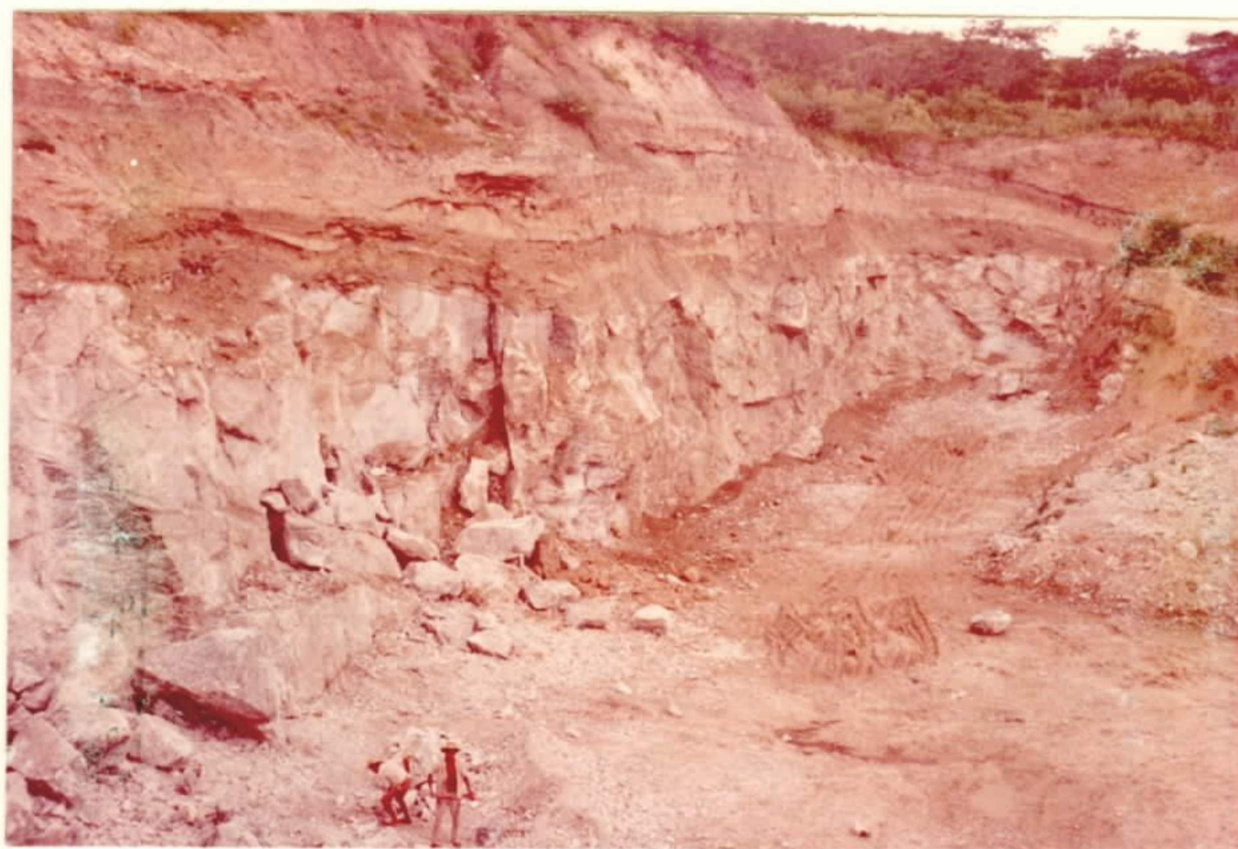
Foto 20 - Outro aspecto da camada de gipsita e seu capeamento, na frente de lavra. Mina Pedra Branca 2, mun. Santana do Cariri.
