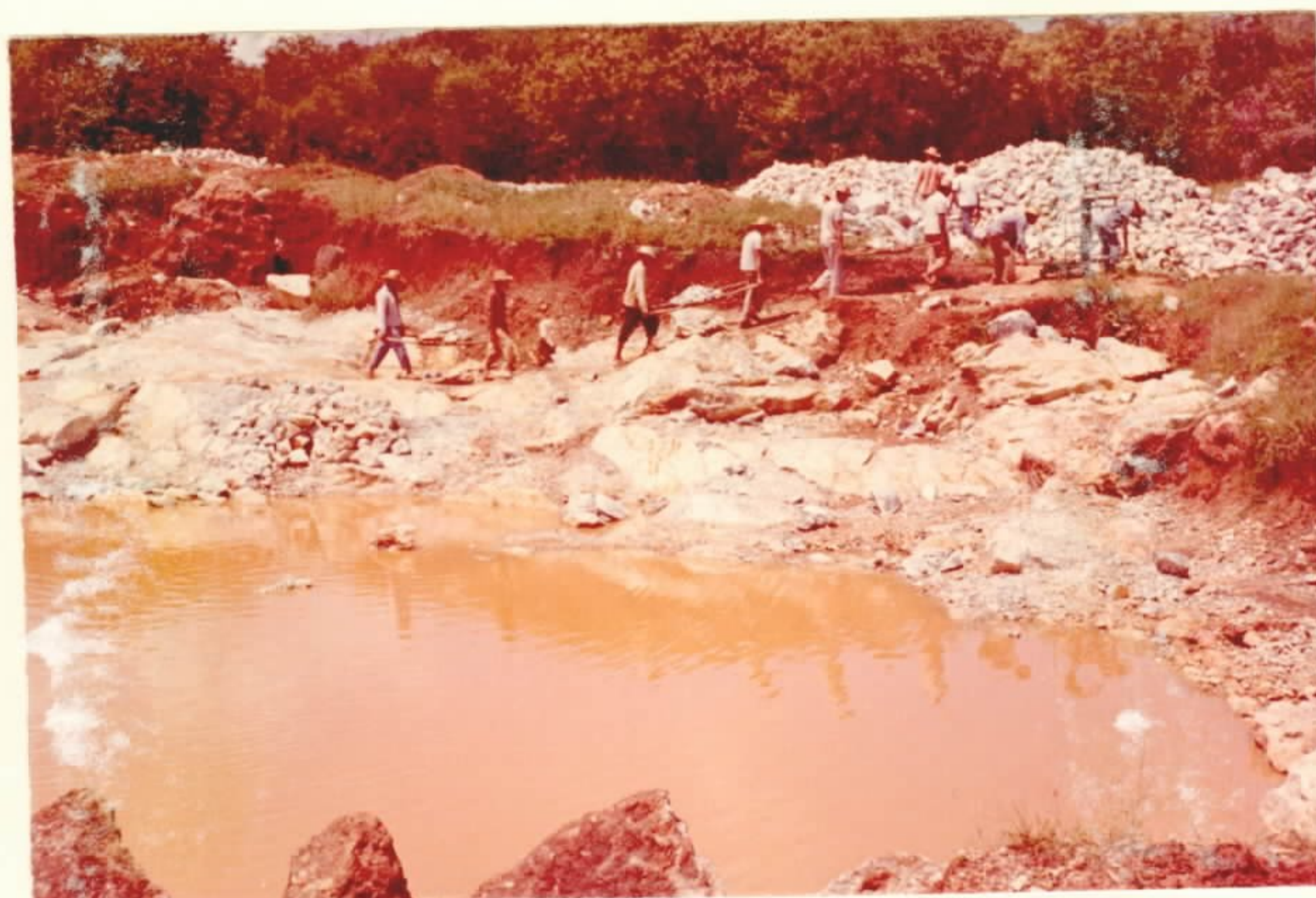
Foto 10 - Transporte da megnesita fragmentada manualmente para a área de estocagem vizinha a de lavra. Distrito de José de Alencar, Iguatu, Ceará.
