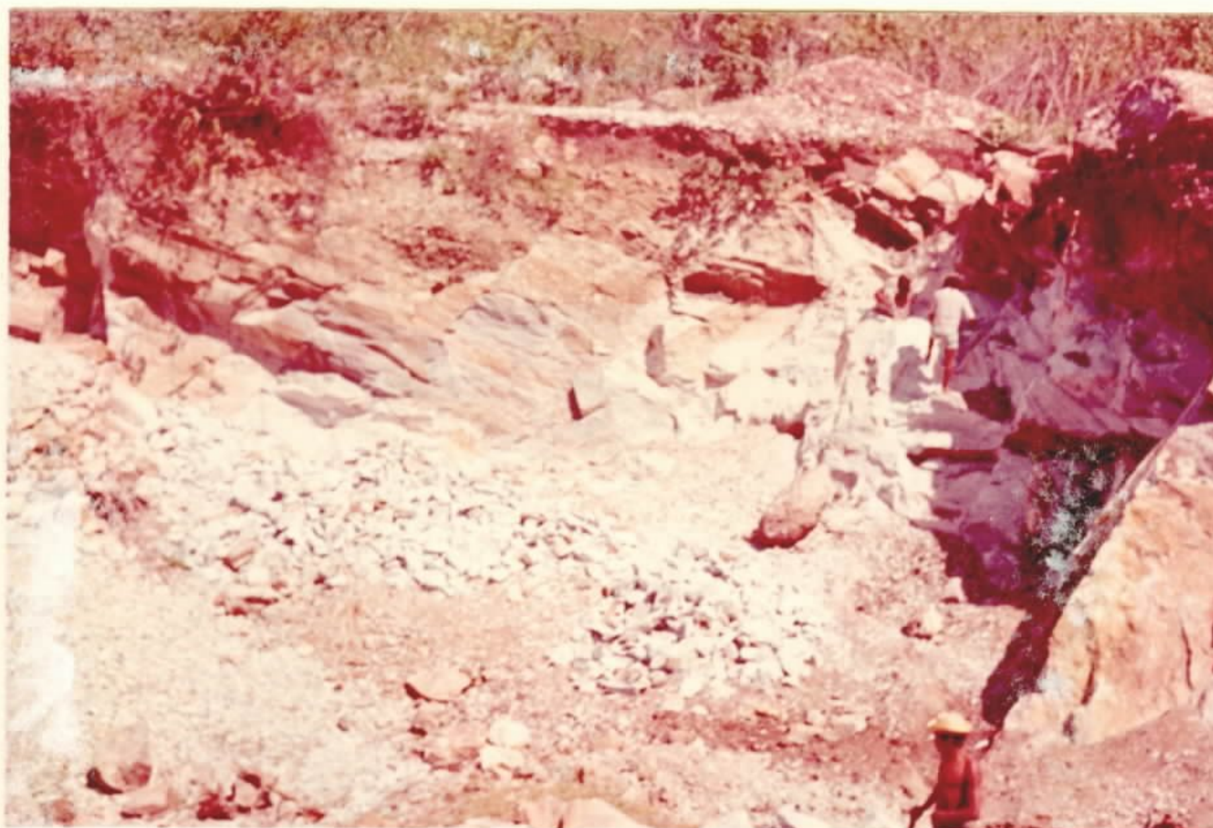
Foto 25 - Desmonte de calcário dolomítico para fabricação de cal. Sítio Preguiça, Distrito de Umirim, Uruburetama, Ceará.
