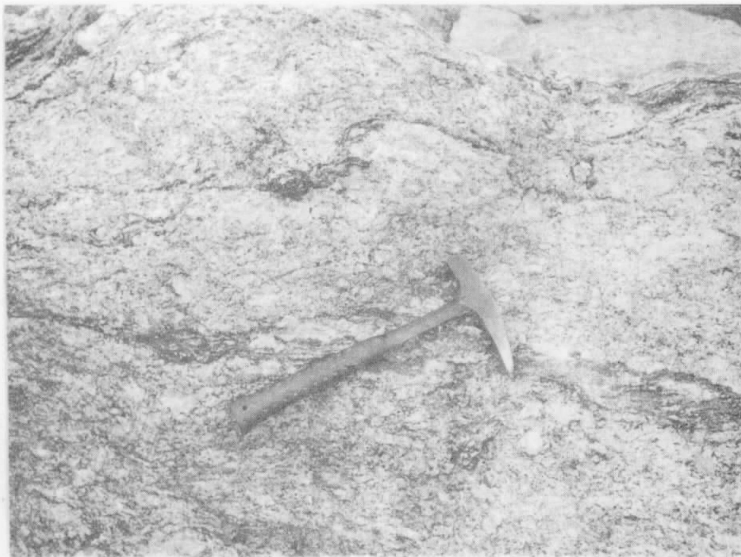
Foto XVI : Gnaisse porfirítico do Grupo Taboleiro, com estrutura pouco orientada, representando um tipo muito evoluído dessa rocha. Intensa blastese de feldspato. Local: matacão junto ao afloramento PK-254, Itapeima (centro-norte da folha de Tijucas).
