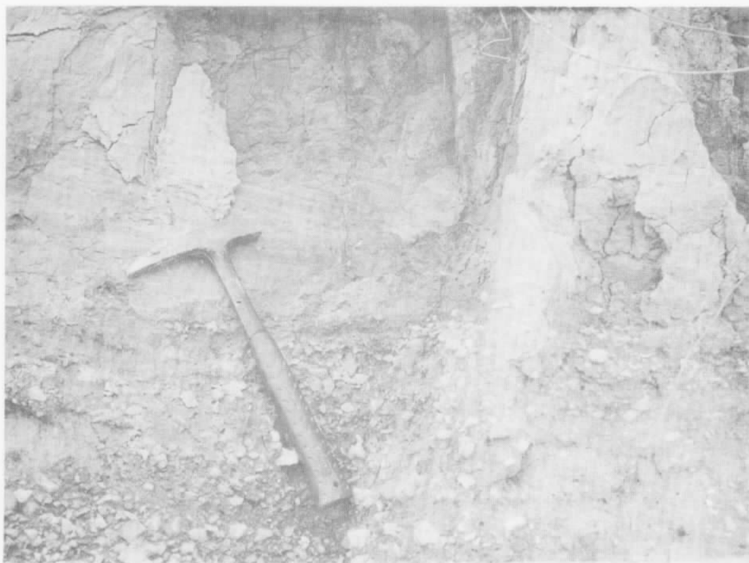
Foto XXXV : Detalhe da foto anterior. Observe-se a fina estratificação na camada argilosa, apontada pelo martelo.
