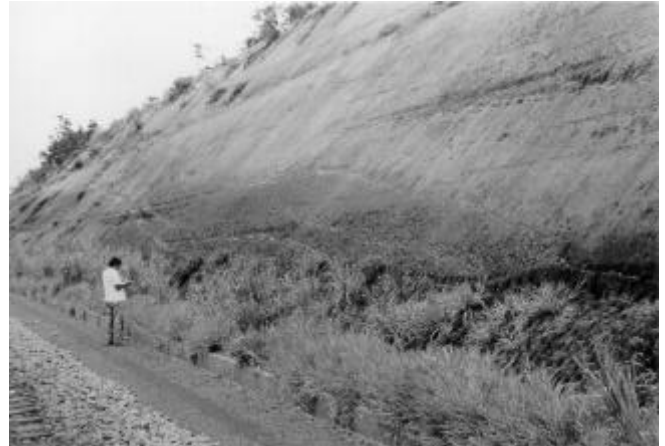
Foto II.2.9 – Discordância erosiva entre sedimentitos da litofacies Acacat da Formação Itapecuru (abaixo) e da litofacies Ad do Grupo Barreiras. Local: corte da Estrada de Ferro Carajás - localidade : Piquiá: Estação VB-34.
