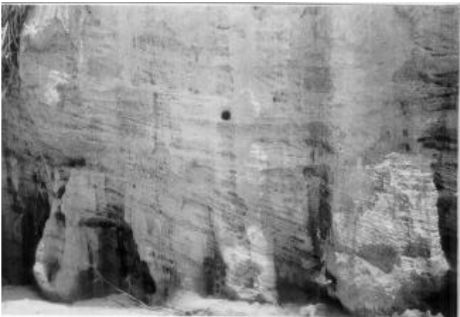
Foto II.2.2 – Litofacies Acacat da Formação Itapecuru, constituída de arenito conglomerático e conglomerado arenítico, exibindo estratificação cruzada tabular principalmente e acanalada de médio porte. Local: BR-222-Novo Bacabal. Estação VB-02.
