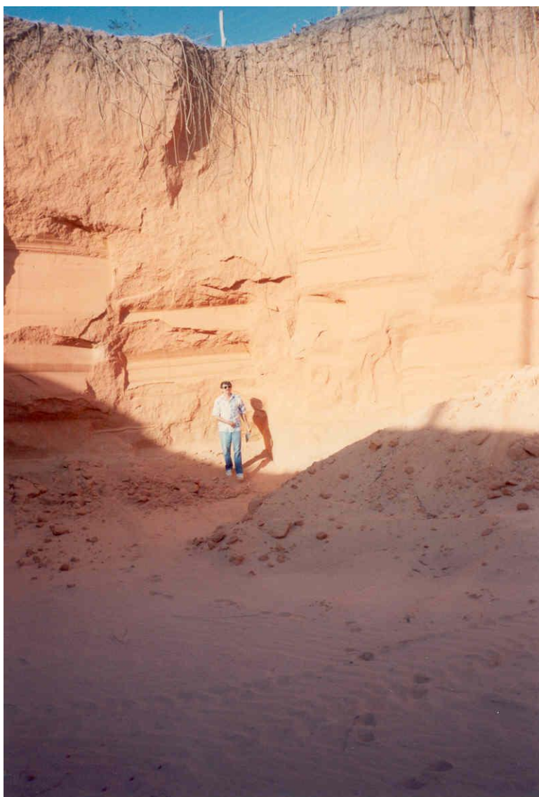
Foto 17: Extensa cava produzida pela mineração de areia em terrenos de páleo-dunas, observando-se taludes verticalizados com cerca de 10 metros de profundidade. Ao lado existe uma estrada, já ameaçada pela escavação. Próximo à Lagoa da Banana, município de Caucaia.
