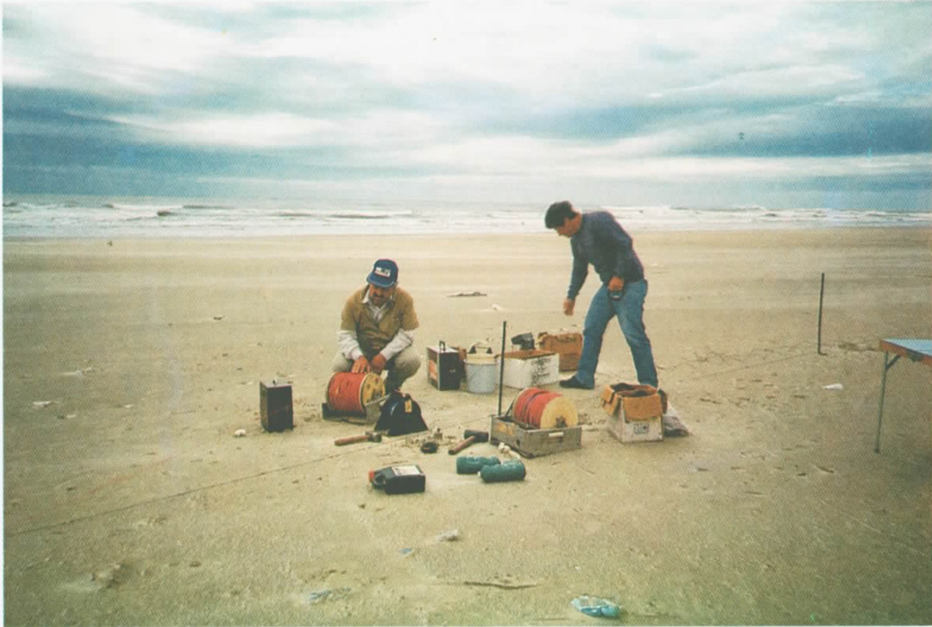
Foto 1 - Montagem do sistema de Eletroresistividade - Sondagem Elétrica Vertical, na praia de Capão Novo.
