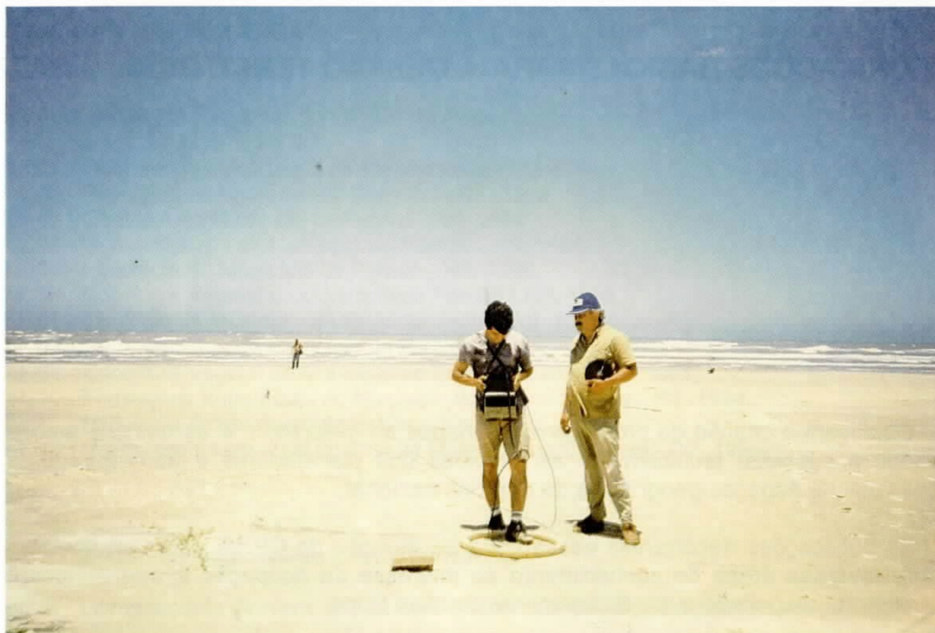
Foto 5 - Medição com o condutivímetro EM-34-3. Transmissor (ao fundo) e receptor (primeiro plano).
