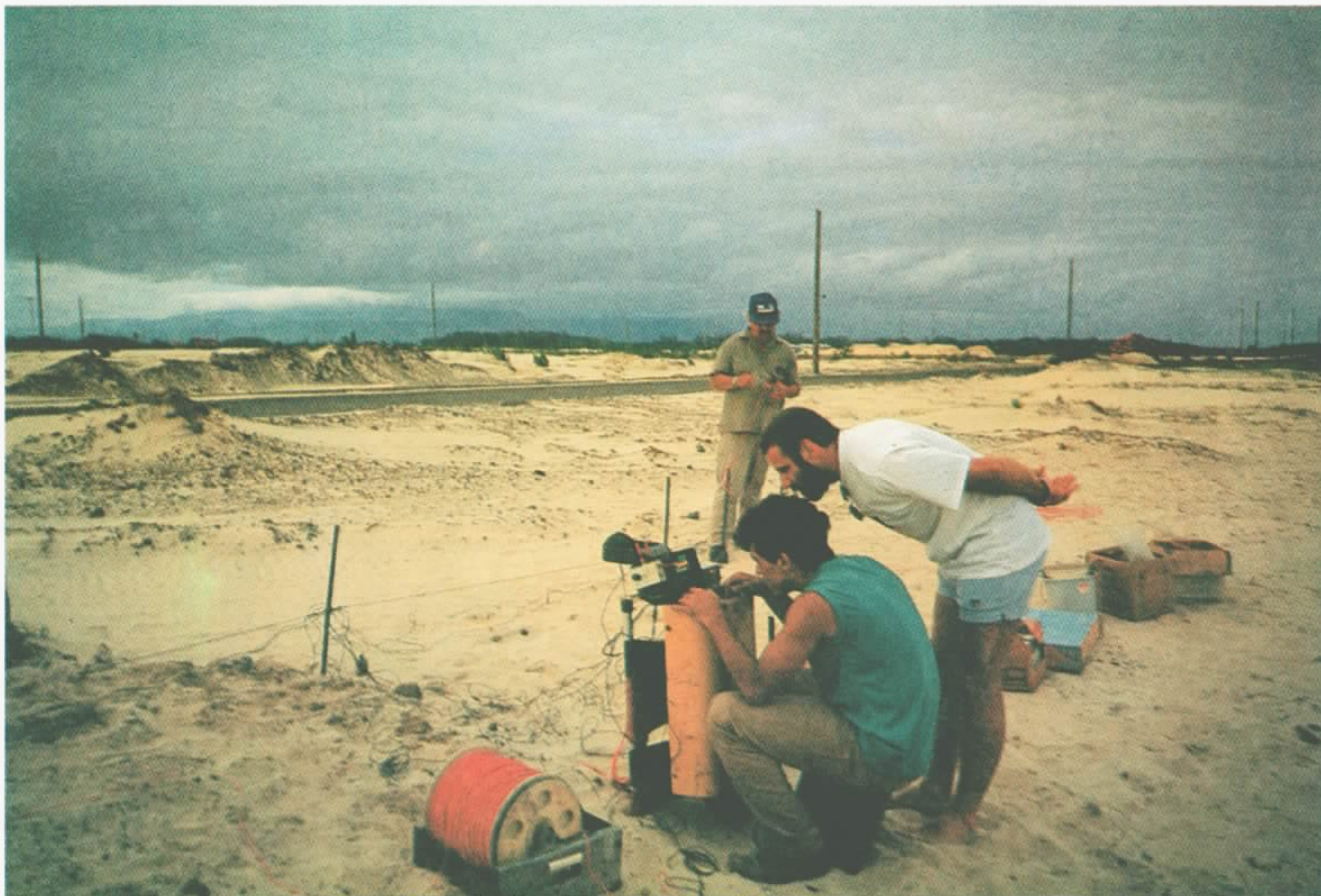
Foto 2 - Execução de sondagem elétrica vertical próximo à Avenida Paraguassú.
