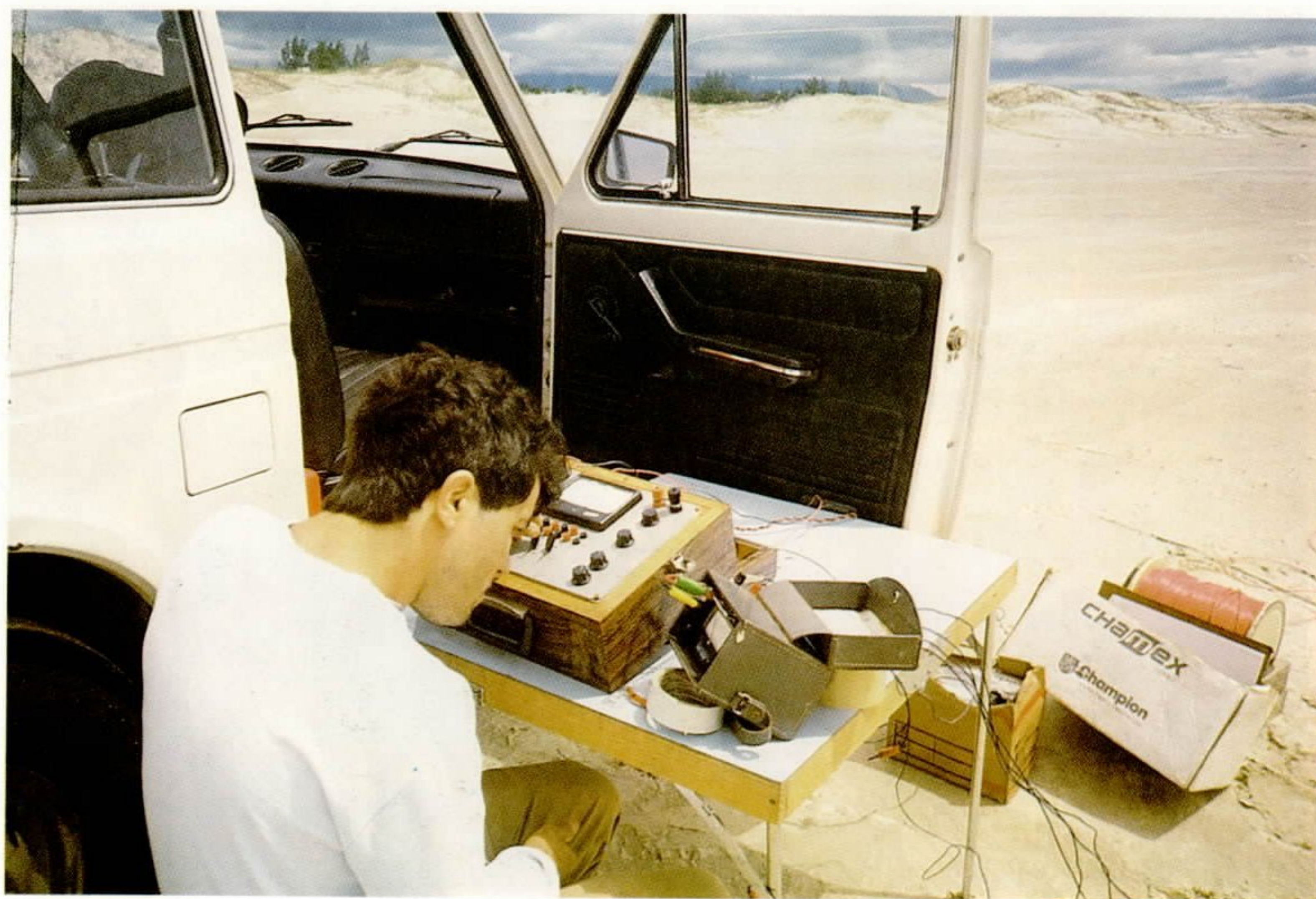
Foto 4 - Detalhe do Receptor de Voltagem do sistema de Eletroresistividade.
