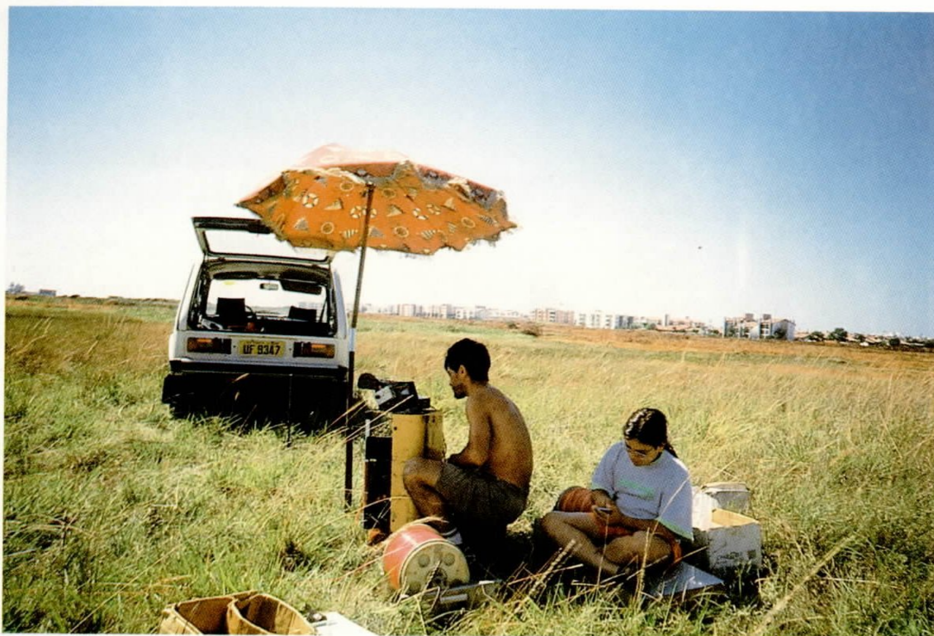
Foto 3 - Detalhe do Transmissor de Corrente do sistema de Eletroresistividade. Ao fundo vista do Balneário de Capão Novo.
