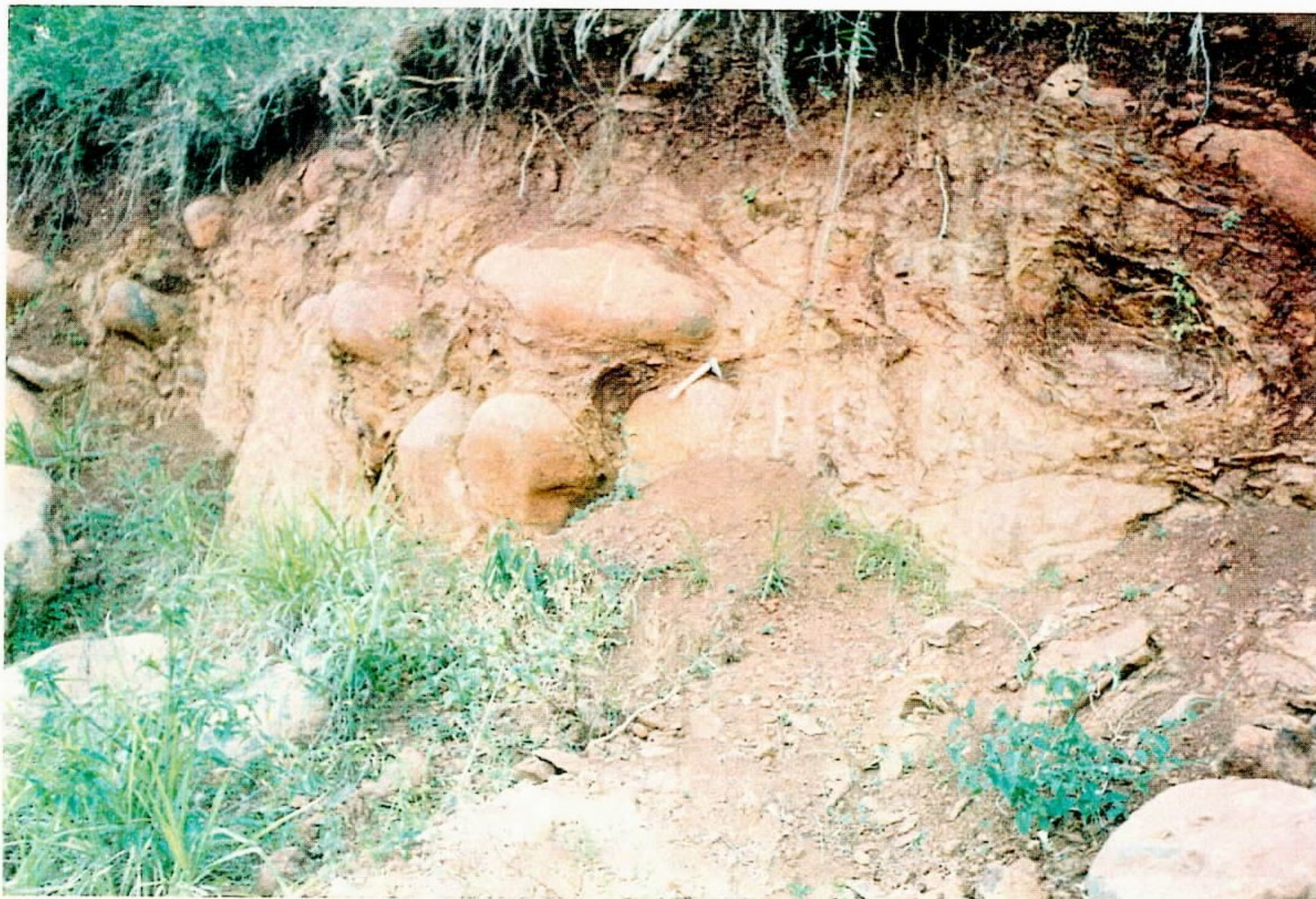
Foto 12 - Solo residual desenvolvido sobre rochas basálticas. Alteração esferoidal destas rochas originam blocos e matacões comuns nestes solos. Ponto próximo ao AK-33.
