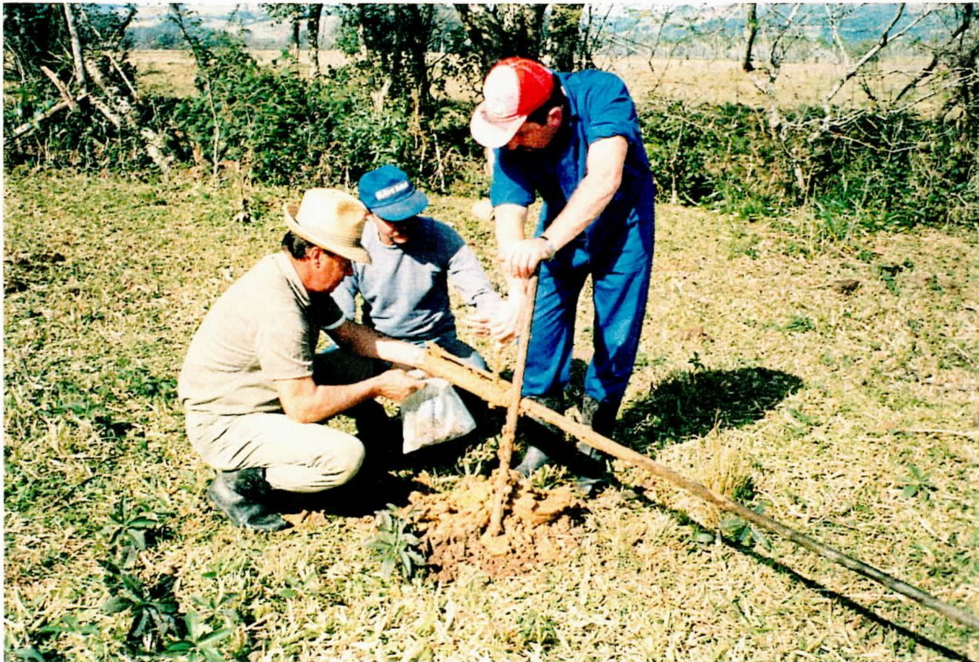
Foto 2 - Detalhe da amostragem do material. Para todos os furos realizados efetuou-se uma descrição litológica e, quando necessário, realizou-se amostragem do material. A broca utilizada é tipo concha com 3" de diâmetro.
