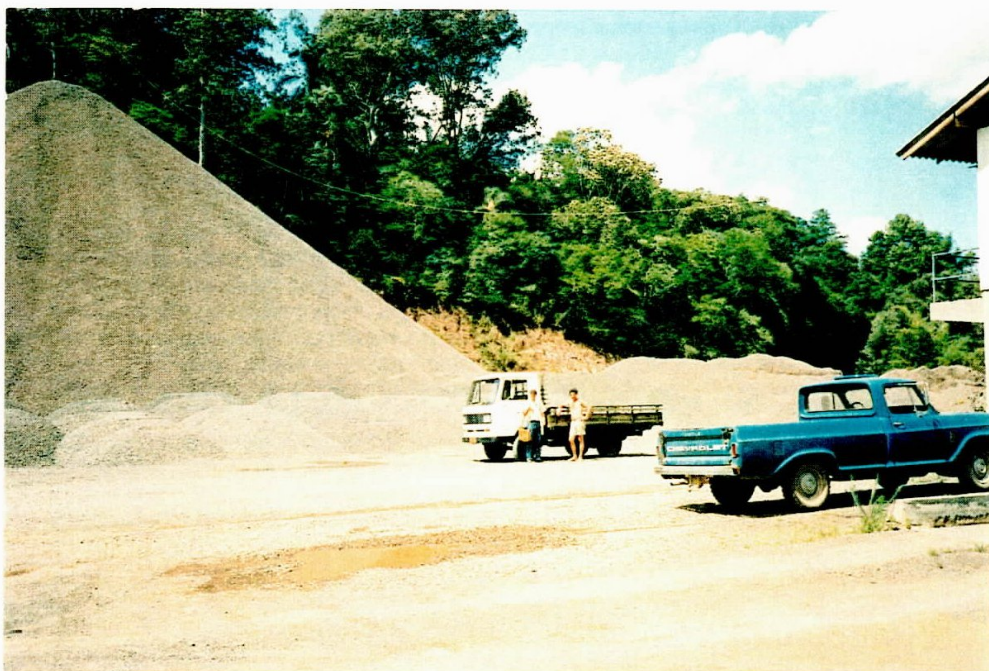
Foto 17 - Expressiva saibreira sobre solos residuais dos arenitos da Fácies de Interdunas da Formação Botucatu. Ponto AK- 03.
