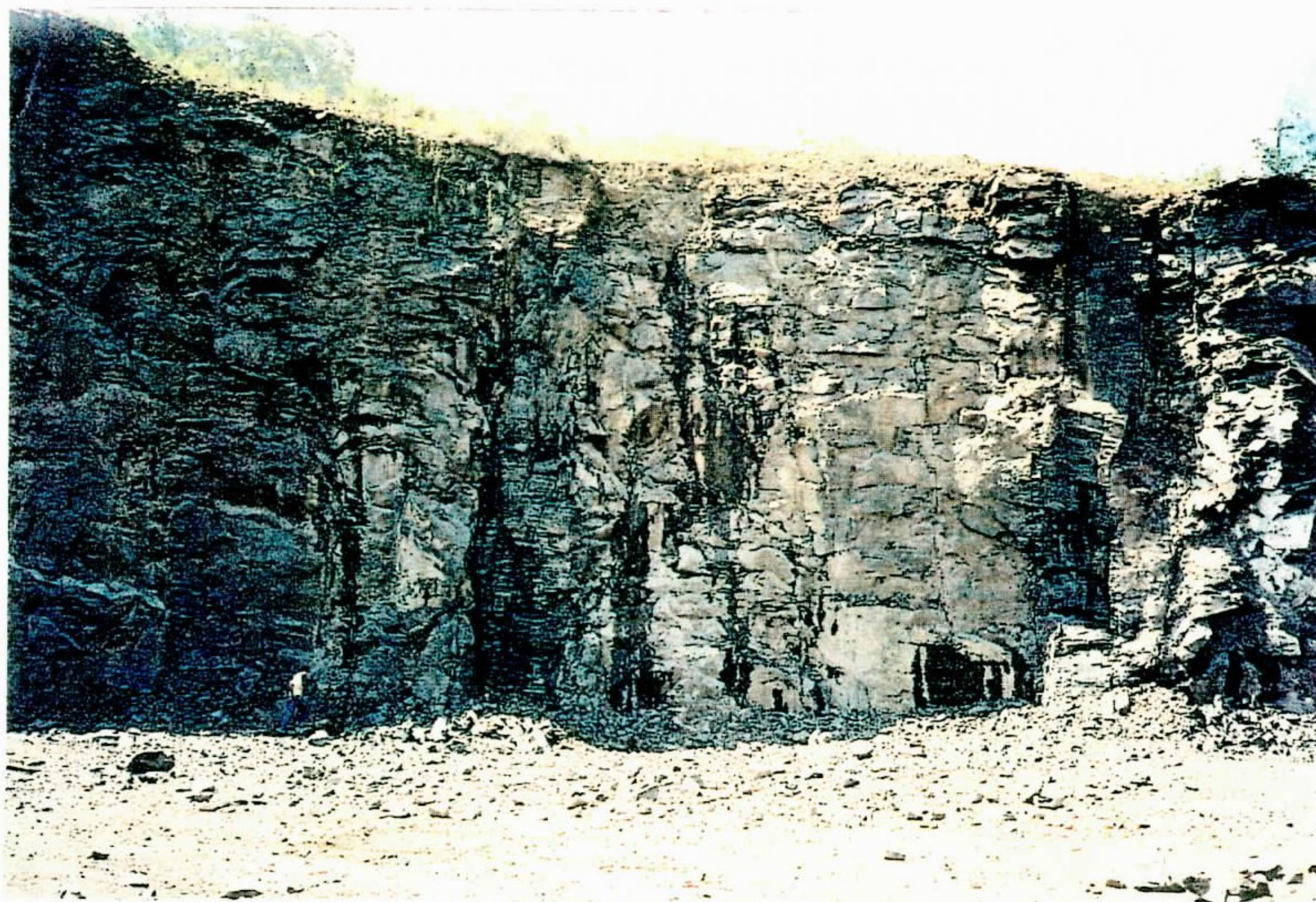
Foto 10 - Pedreira de rocha basáltica. Observa-se, no canto direito da foto, um dique de diabásio seccionando as rochas basálticas da Formação Serra Geral. Ponto AK-37
