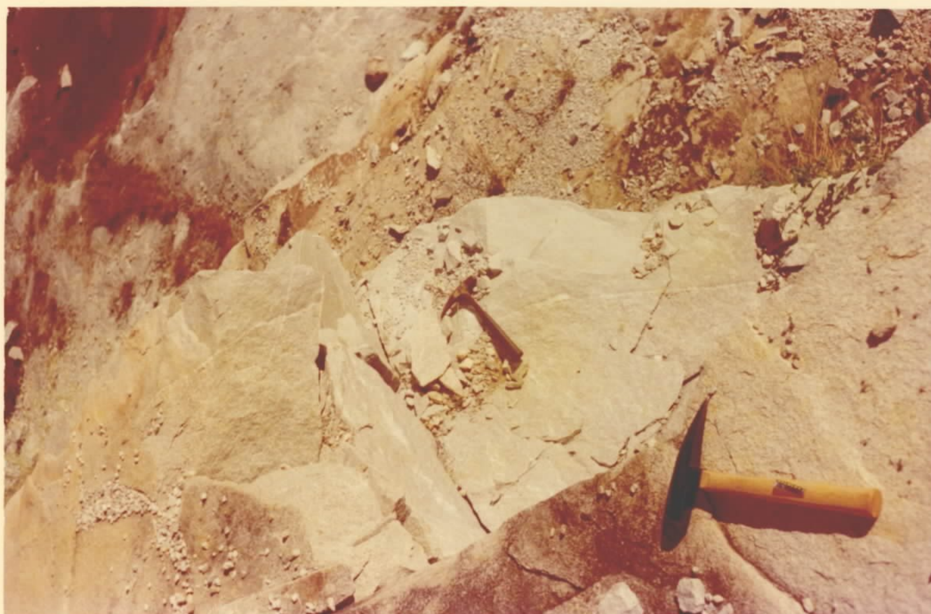
FOTO 08 – Rocha granítico-granodiorítica da Unidade I (pçl), na BR-153, pouco a norte do rio São Patrício. Pequenos veios de composição granítica e textura fina recortam a rocha.
