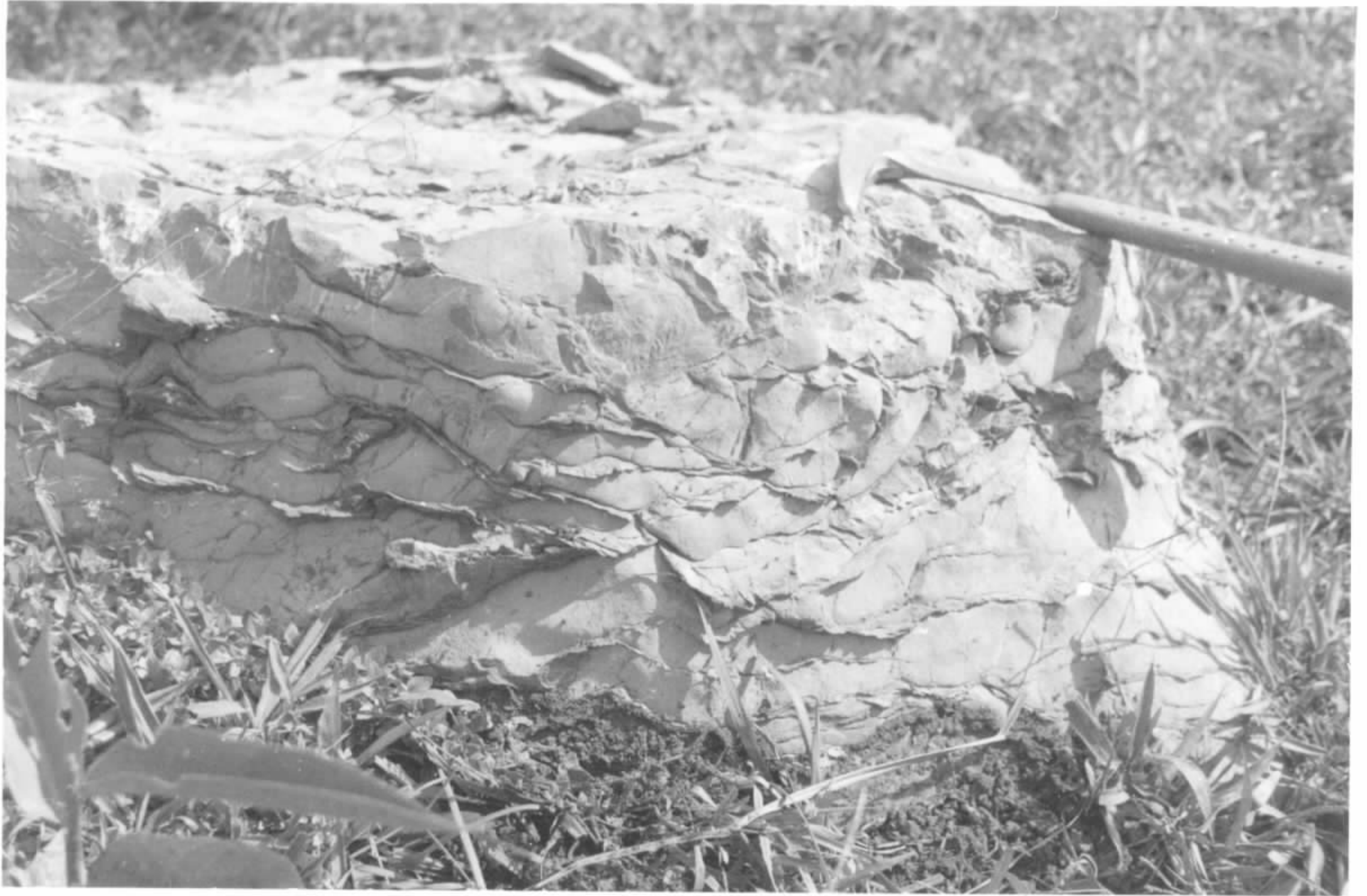
FOTO 46 — Afloramento de calcário argiloso do Membro Calcítico ( \mathcal{Q}bc ), da Formação Bocaina ( \mathcal{Q}b ) — Grupo Corumbá, exibindo estratificação ondulada, ressaltada pelo desenvolvimento de lâminas de material argilo-carbonático, preferencialmente entre os níveis de estratificação.
