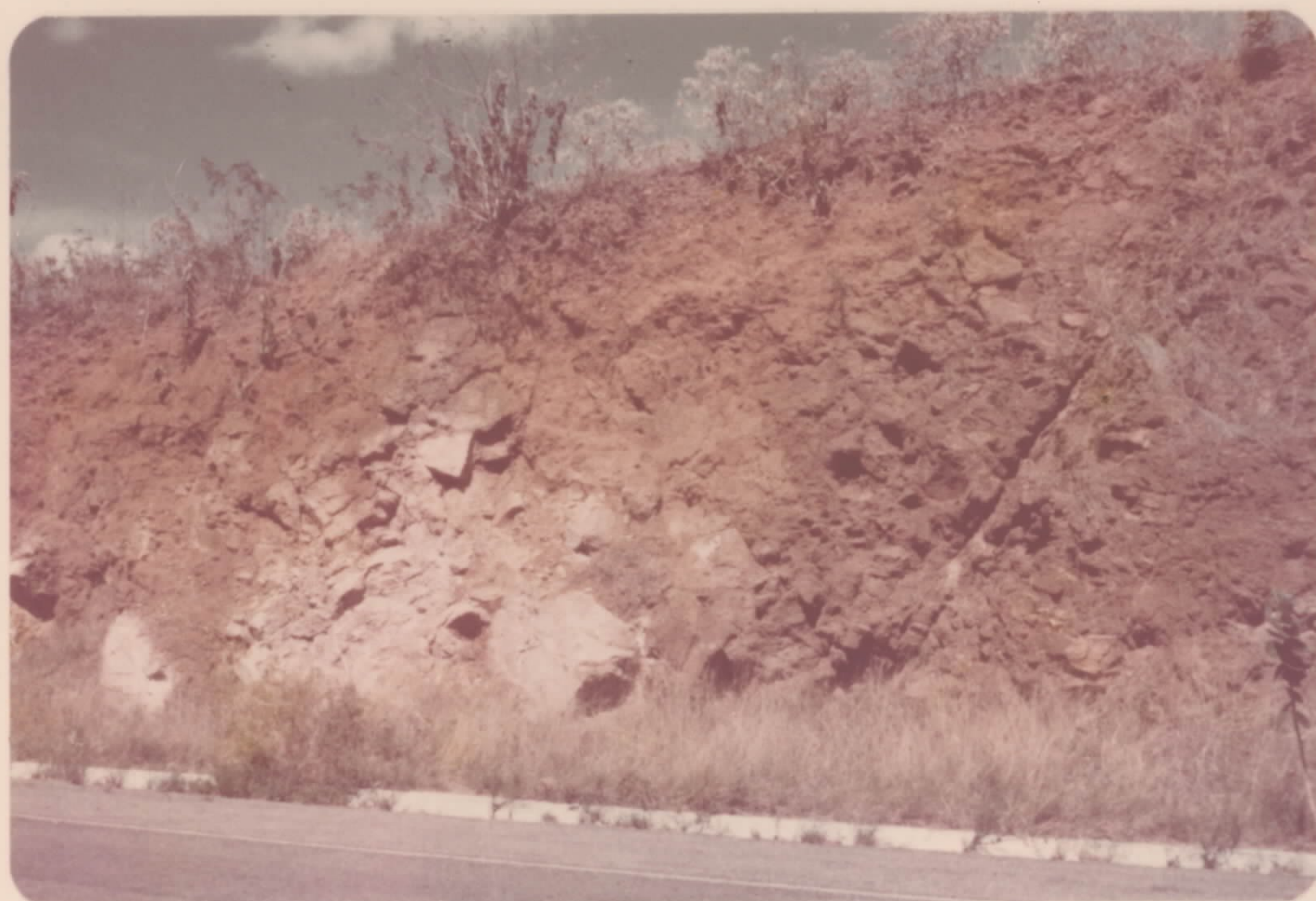
FOTO 8- Capa sílico-ferruginosa sobre ub com mais de 5 m de espessura e solo característico - pEip (BA-052 - km 106).
