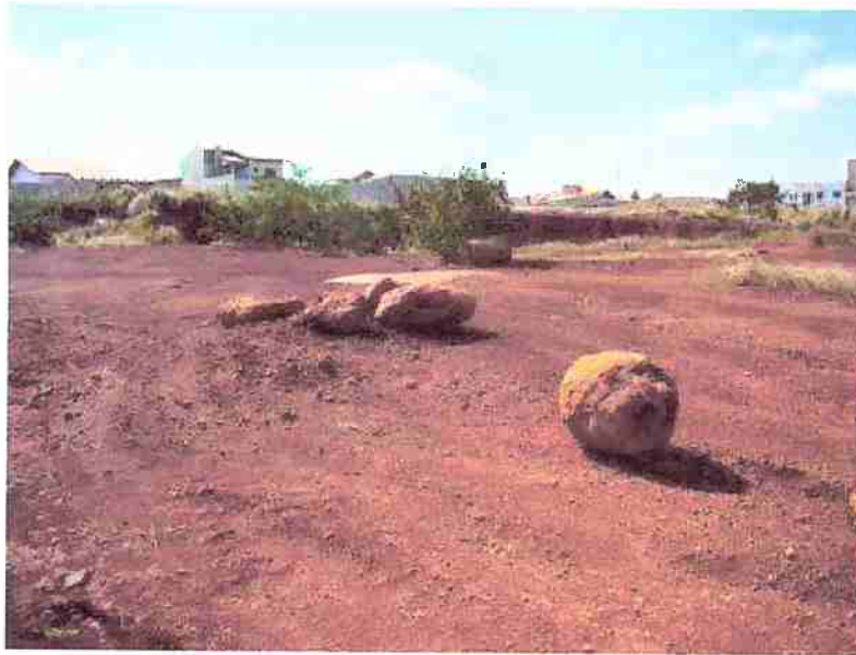
Foto 2.37: Mostra um aspecto comum aos terrenos basálticos. Mesmo onde os solos são profundos e bem evoluídos, devido à forma com que se alteram os basaltos, podem ocorrer blocos e matacoes, uma característica que, localmente, pode dificultar a execução de escavações, perfurações e trazer problemas para fundações de obras. Periferia de Marechal Cândido Rondon.
