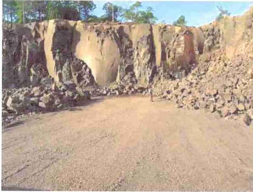
VC-30 – Pedreira Tupy. Basalto tipo Cordilheira Alta. Destaque para o desenvolvimento de lisas paredes côncavas-convexas formadas por disjunções colunares bastante espessadas. BR-280, cerca de 15km da cidade de Palmas.
