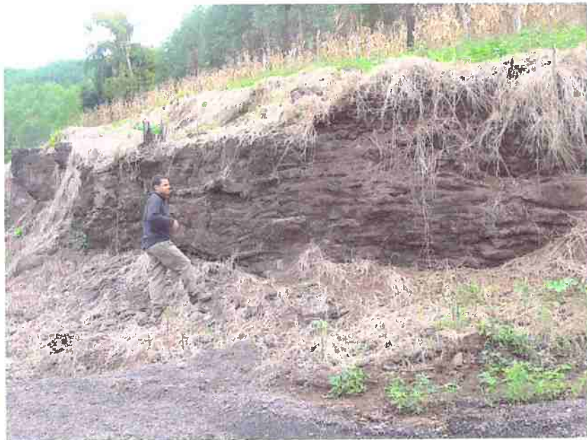
EG-35 – Afloramento na BR-487, à aprox. 20 km de Iretama. Neste ponto observa-se o forte padrão tabular de disjunções levemente onduladas, provavelmente pelo fluxo da lava. Ocorre intercalação entre zonas altamente vesiculares e zonas mais maciças.
