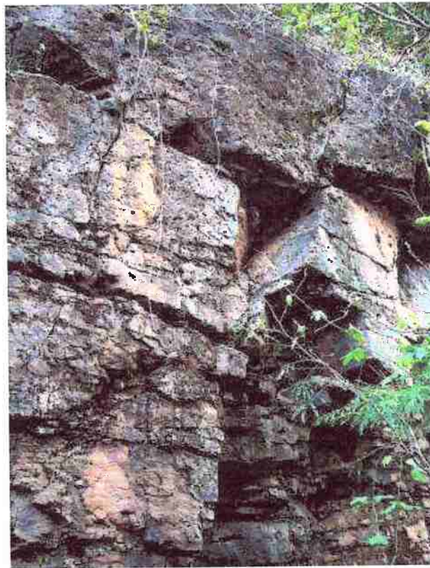
Foto 2.10: Basalto vesiculado, é possível também notar fraturamentos verticais e horizontais, com alta permoporosidade secundária geralmente observando-se surgência de água nas fraturas.
