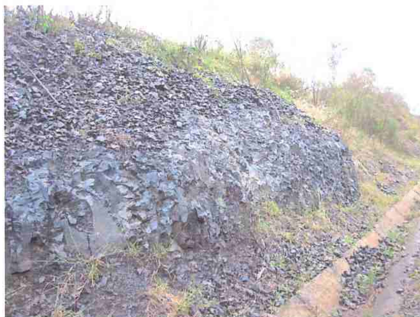
VC-42 – Corte na BR-487 próximo à cidade de Turvo. Basalto preto de granulação muito fina com fraturamento irregular e natural, formando pequenos cubos. Características típicas do fácies Nova Laranjeiras.
