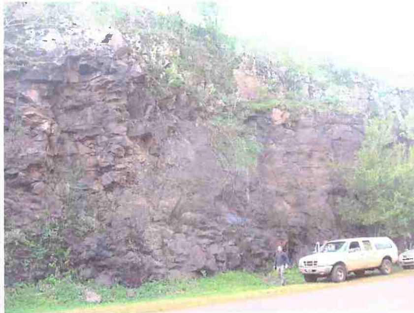
VC-67 – Corte na RN-14. Basalto maciço de granulação fina, cor cinza avermelhado, sem grande quantidade de vesículas. Magma tipo Paranapanema, fácies Cordilheira Alta.
